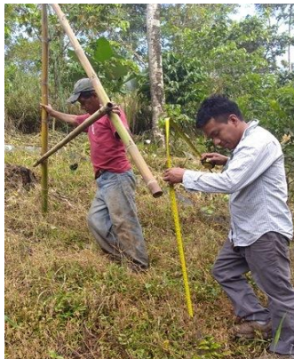
Figura 9. Medición de pendiente
