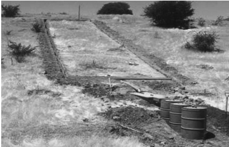
Figura 4. Parcela de escorrentía. (Estándares de ingeniería para aguas y suelos - EIAS, 2005).
