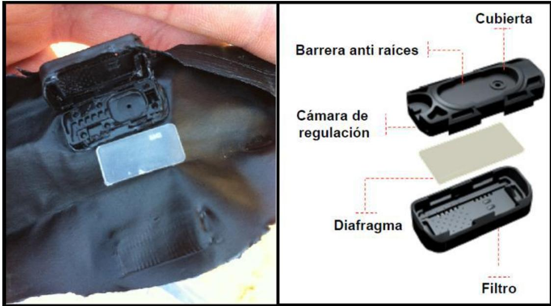
Figura 15. Partes internas de un gotero DripNet PC 16125.
