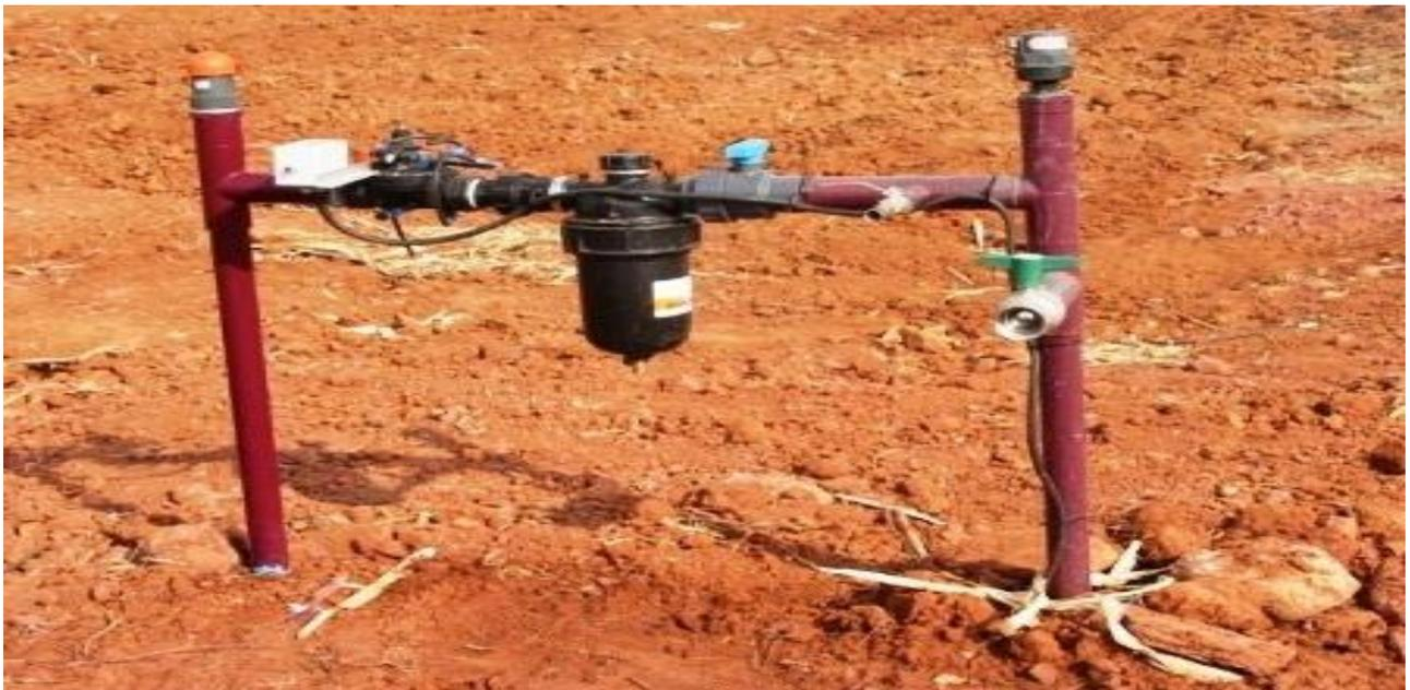
Figura 14. Válvula de puente (Netafim, Características del riego por goteo.- Sugarcane)
