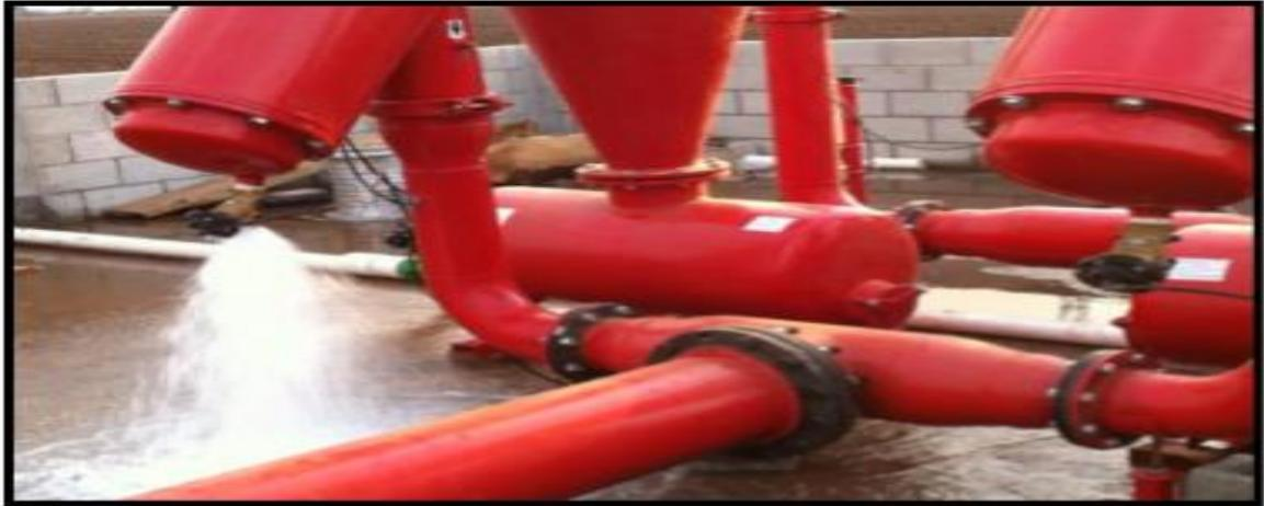
Figura 13. Apertura de la válvula hidráulica del retro lavado (Franco, 2014).
