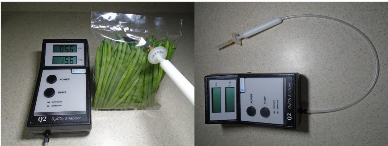
Figura 5. Analizador de O<sub>2</sub> y CO<sub>2</sub> utilizado.
