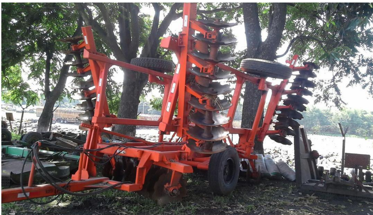
Figura VII. Rastra pulidora de tiro excéntrico de secciones adicionales tipo velera.
