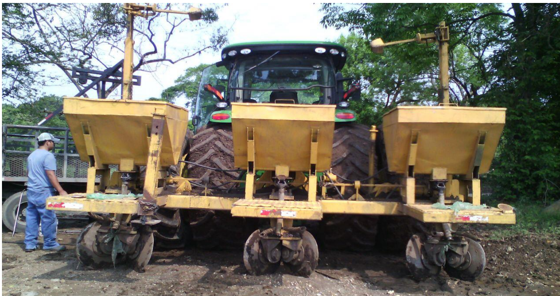
Figura XI. Surcado de tres cuerpos de discos de 24 pulgadas de diámetro.
