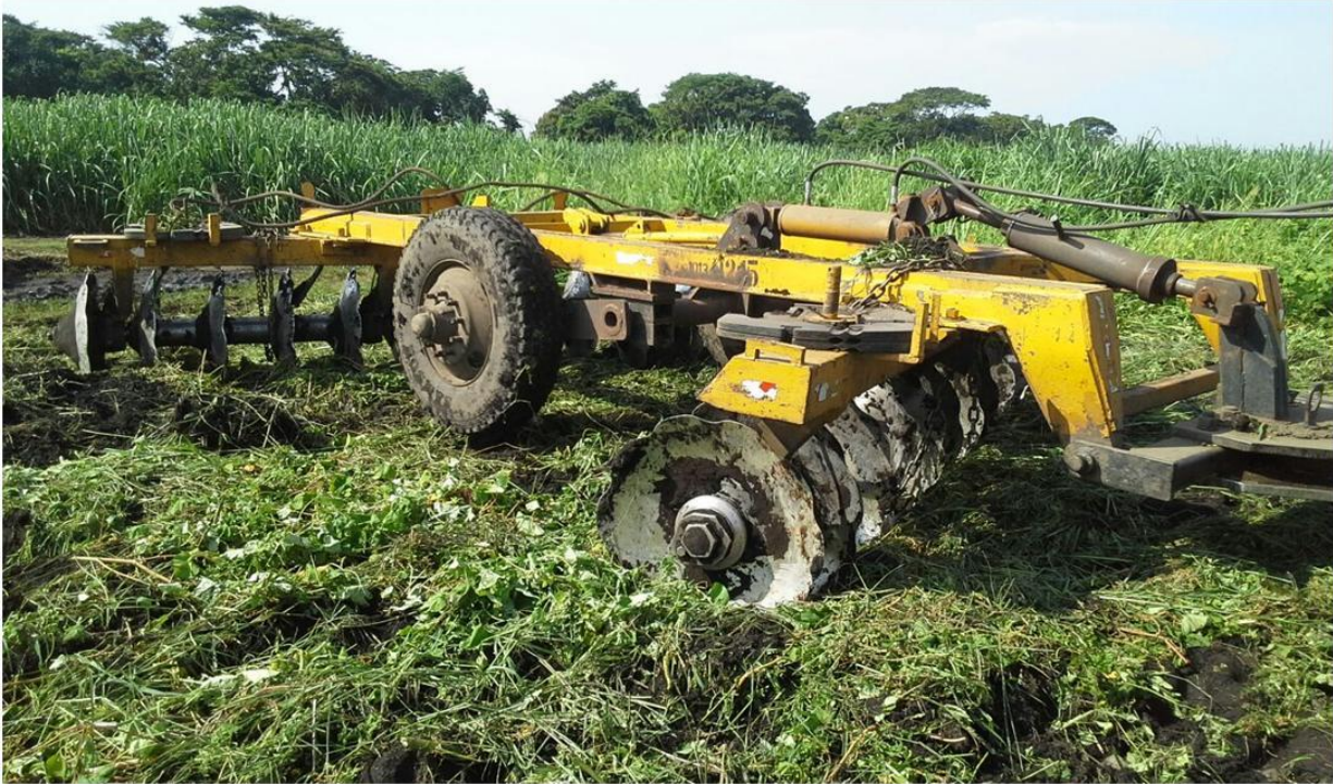
Figura IV. Rastro arado excéntrico de cuatro secciones de 20 discos de 24 pulgadas, del área a trabajar las cabeceras alrededor se pueden hacer al inicio si las crestas de los surcos son muy altas para facilitar la vuelta del tractor e implemento (melgas de afuera hacia adentro), o al final de laborar el resto del área (melgas de adentro hacia afuera), tal como se muestra en la figura 5 y 6.
