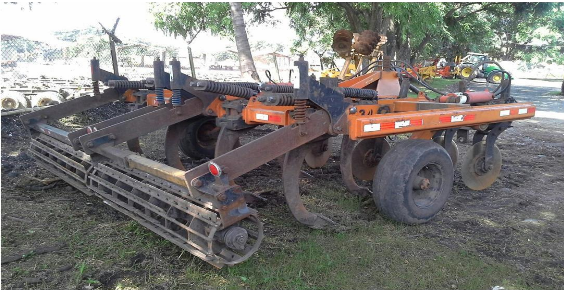
Figura III. Arado de cinceles con rolo con enganche a la barra de tiro.
