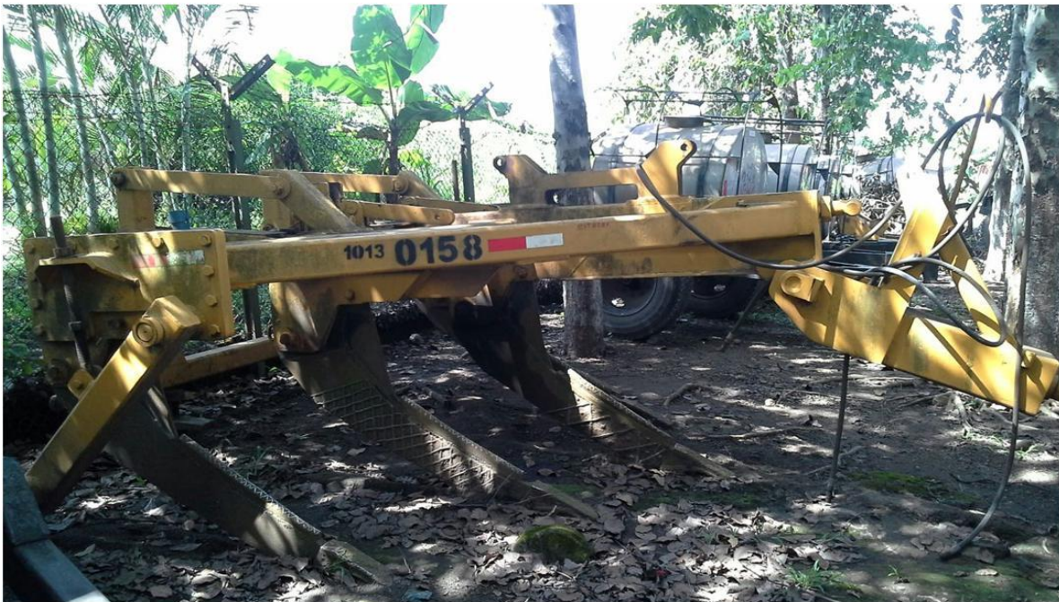
Figura VIII. Subsolador de tiro de 7 puntas de 3 pulgadas de diámetro por 1 m de altura.
