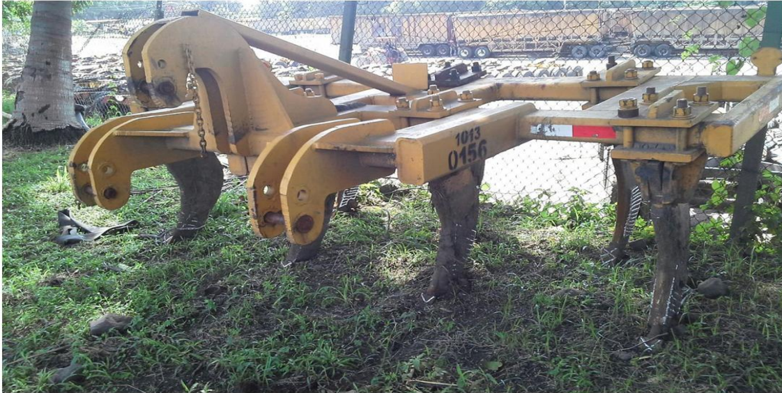
Figura II. Arado de cinceles integral con enganche al sistema de tres puntos del tractor.
