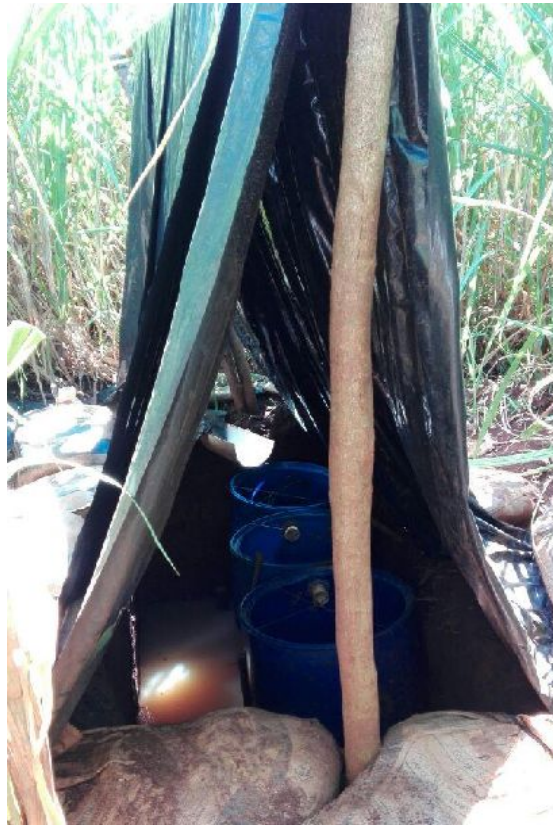
Figura 10. Protección de los toneles para evitar contaminación, en cada parcela de escorrentía, finca San Mauricio, Ingenio Magdalena (Zafra 2014/2015).
