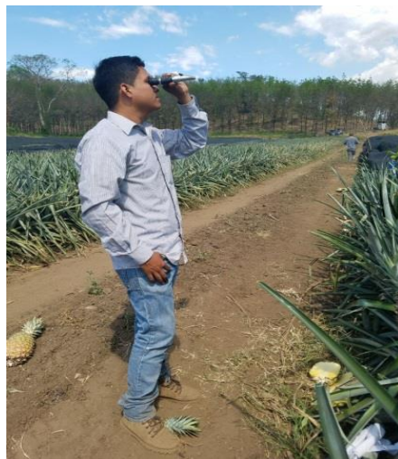
Figura 6: Observación en el refractómetro manual para la toma de datos de sólidos solubles totales (% Brix).
