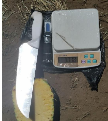
Figura 5: Equipo y herramientas utilizadas para la medición de pesos y la concentración de sólidos solubles totales (% Brix).
