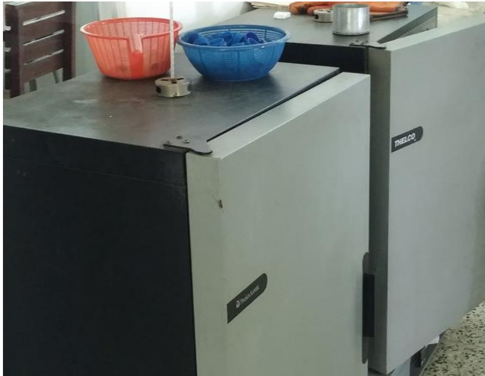
Figura. 21. Horno de Secado del suelo para cálculo de la erosión. Fuente autor:
