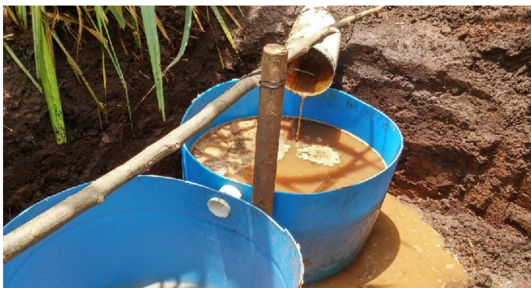
Figura. 18 Colectores de agua de escorrentía y erosión. Fuente: autor
