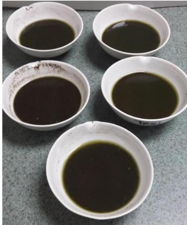
**Anexo 15. Secado de lodos tratados a una temperatura de 110°C por 48 horas.**
