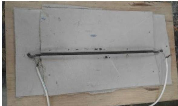
*Imagen N°27.* Tabla de asbesto sobre una tabla de madera, en la que se colocó una resistencia eléctrica.
