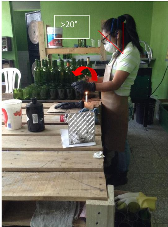
*Imagen N°99* Sistema actual de corte, supera los  $20^\circ$  de inclinación del cuello (el cuello está pegado a la parte del pecho) y se hace durante un tiempo prolongado, se presentan movimientos repetitivos al hacer girar la botella manualmente, lo que causa fatiga al operario, dolor de cuello, espalda y mano.
