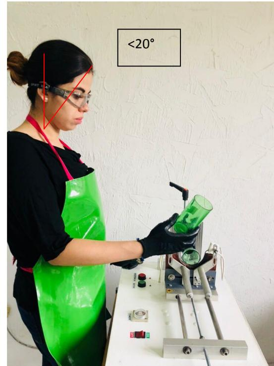
*Imagen N°100* Sistema nuevo, la inclinación es menor a  $20^\circ$ , y por menor tiempo, se elimina el movimiento repetitivo de la mano, lo cual disminuye significativamente la fatiga, volviendo al operario más productivo.
