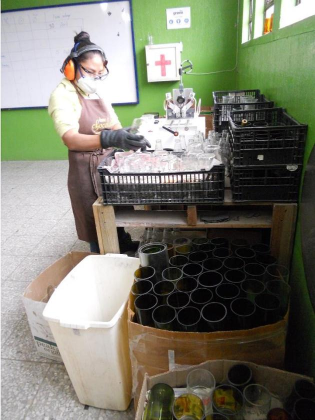
*Imagen N°125 En caso de que las canastas se llenen, se deben llevar al área de almacenamiento para que pasen al área de pulido, luego llevar nuevamete las canastas vacías al área de corte.*
