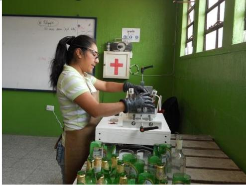
*Imagen N°91 Operaria colocando una botella para cortarla.*
