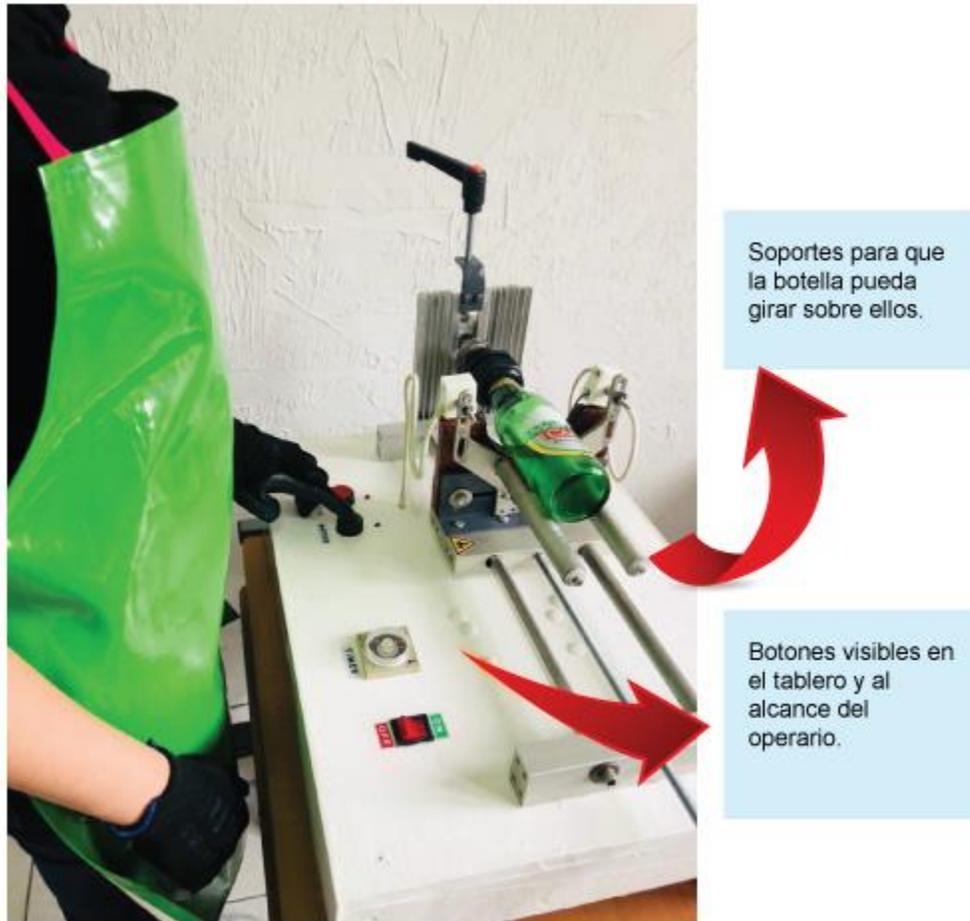
*Imagen N°75. Optimus kutt. Características del sistema de corte.*
