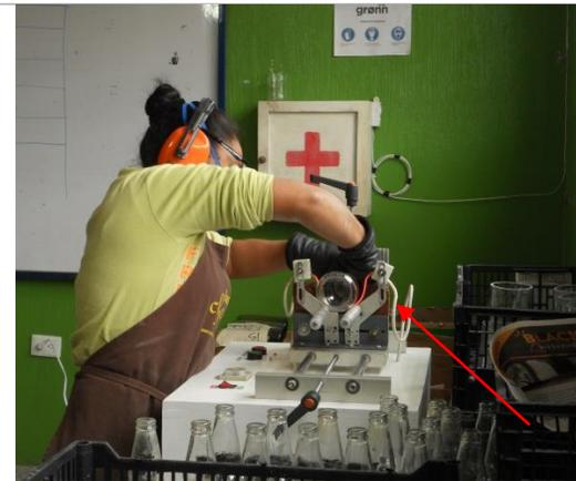
*Imagen N°112 Operaria retirando el vaso de los rodillos y la boquilla de la botella del bushing.*
