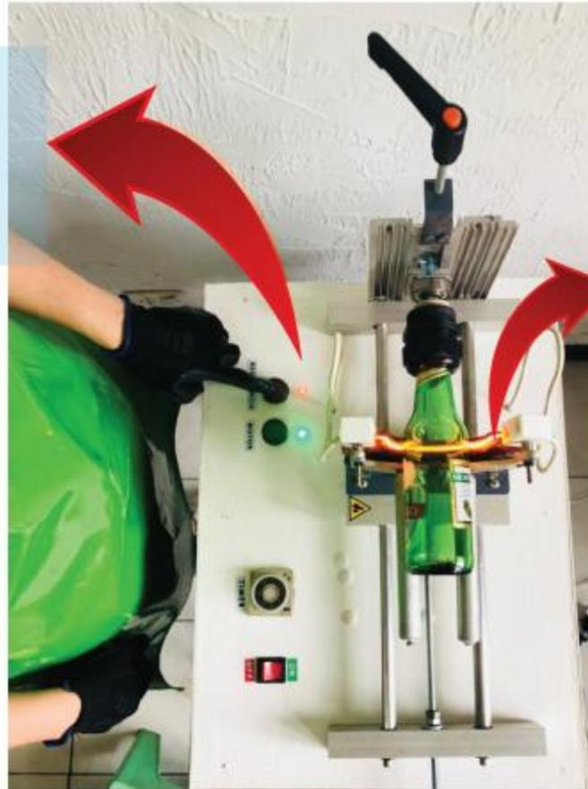
Resistencia de níquel a la vista del operario. Esta se calienta en aproximadamente 5 segundos, se caracteriza por su alta durabilidad.
