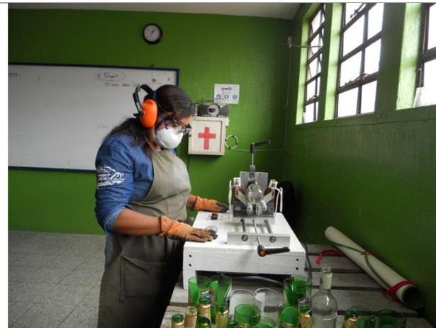
*Imagen N°96 Operaria cortando botellas con Optimus Kutt.*
