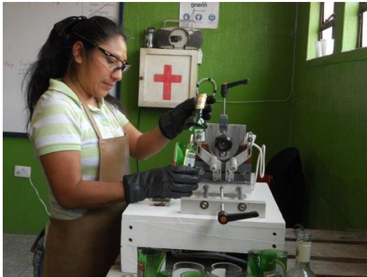
*Imagen N°95 Operaria retirando las partes de la botella cortada.*
