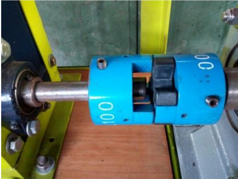
Imagen 65: Acople desconectado para ser utilizada de forma manual
