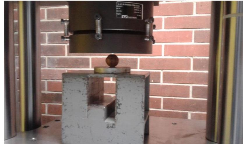
Imagen 25: Prueba del punto de ruptura de la macadamia
