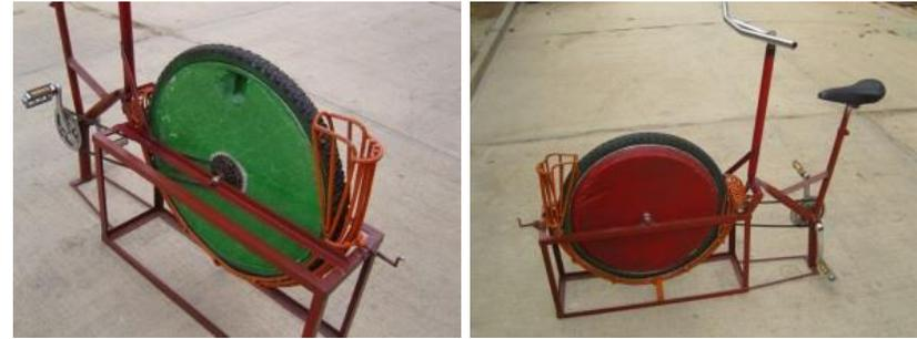
Imagen 17 y 18: Bici-máquina descascaradora de macadamia (Maya Pedal)
