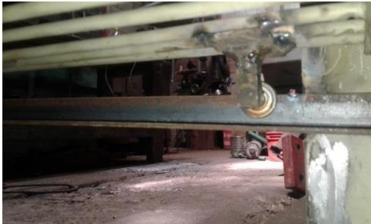
Imagen 51: Modo de separación por medio de rodos
