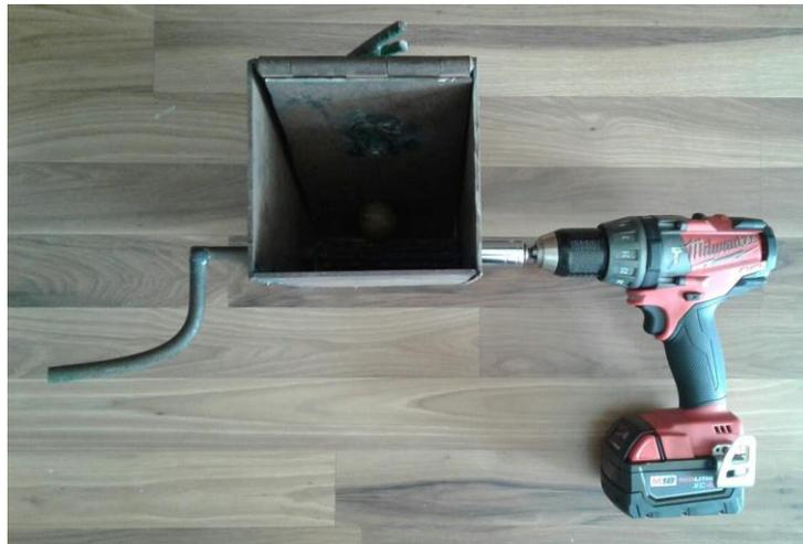
Imagen 43: Prueba de torque requerido para descascarar macadamia
