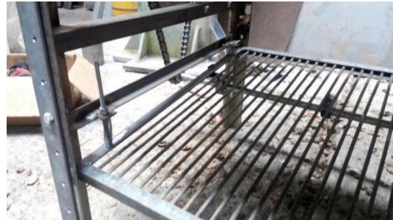
Imagen 52: Modo de separación por medio de una leva y resortes
