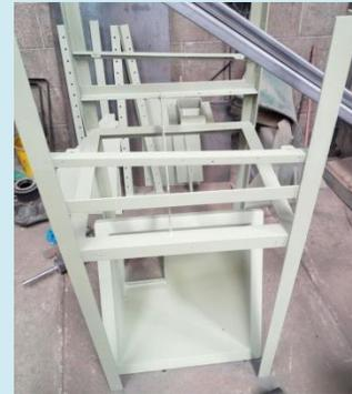
Imagen 91: Estructura con pintura de fondo
