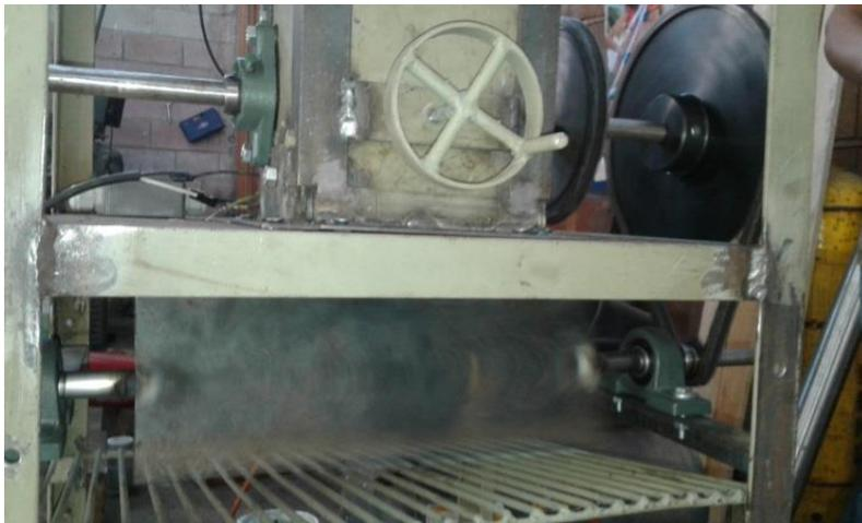
Imagen 53: Modo de separación por medio de una paleta giratoria
