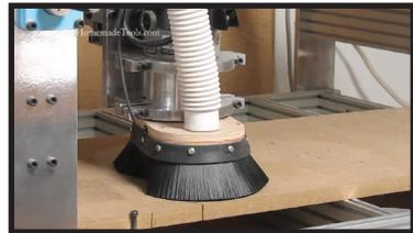
Imagen 20. Sistema de extracción de residuos
