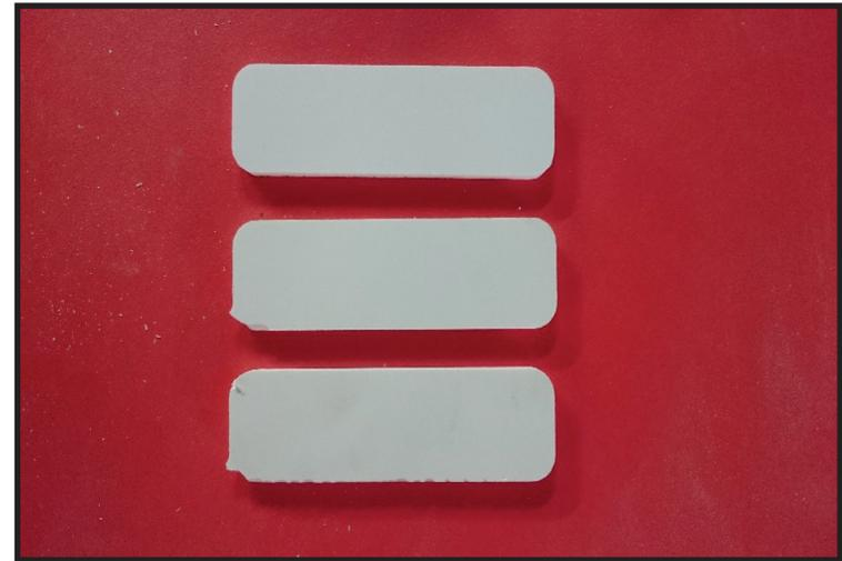
Imagen 23. Defectos causados por saltos en la cadena de movimiento
