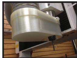
Imagen 21. Sistema de extracción de residuos
