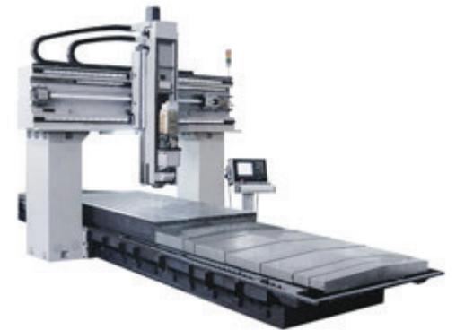
Imagen 16. Fresadora de pórtico
