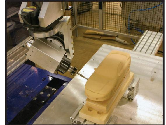
Imagen 9. Corte con máquina CNC de cinco ejes
