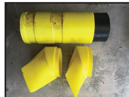
Imagen 48: Boquillas intercambiables
