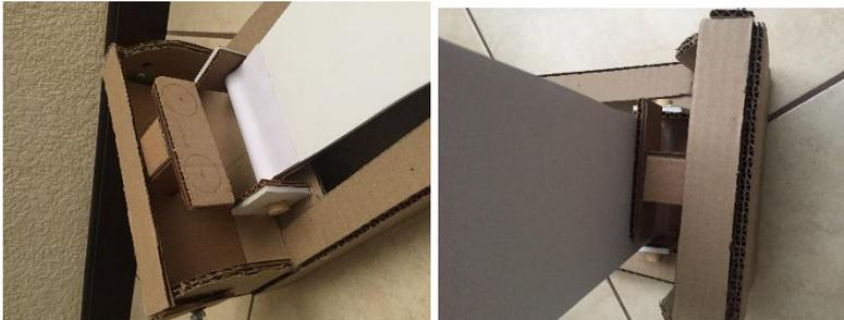
Maquetas de cartón a escala 1:1, con base plana que en su interior poseen cuatro pernos para graduar la altura según el tipo de suelo. En el frente un mecanismo adaptable en diferentes ángulos y con dos imanes para mantener el blanco en posición vertical y así evitar que el viento lo derribe y su reconfiguración sea más sencilla.
