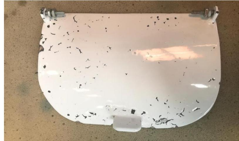
*Imagen 55: Defecto de escama en el proceso de peltrado en tapadera*
