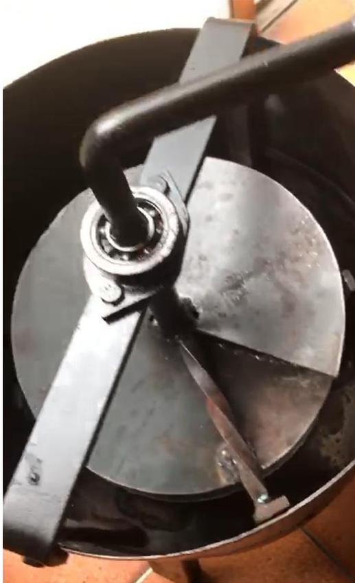
**Imagen 37: Detalle varillas molidoras**
