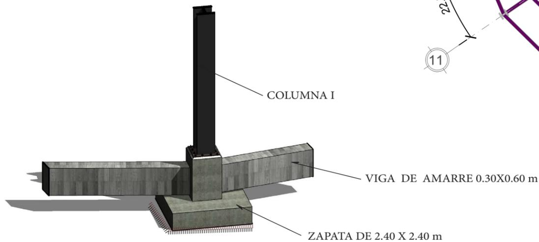
DETALLE DE CIMENTACIÓN DE ESTRUCTURA METÁLICA
