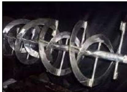
Ilustración 16. Interior de una mezcladora de cinta doble
