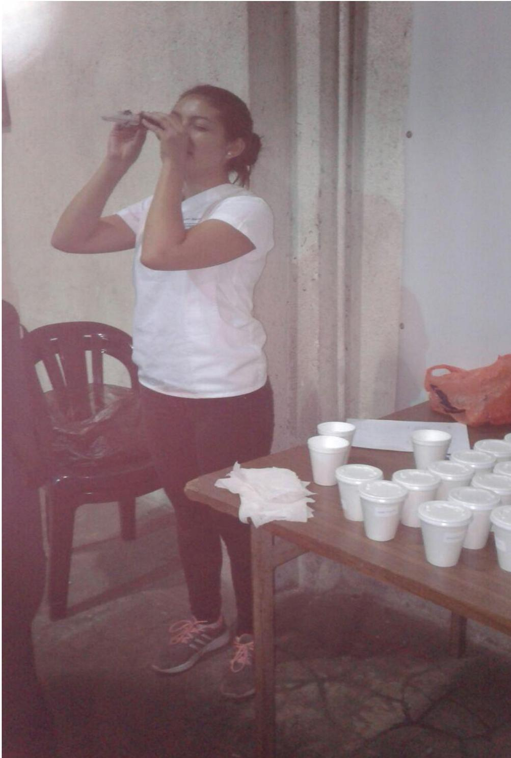
**Determinación de la densidad urinaria utilizando el refractómetro.**
