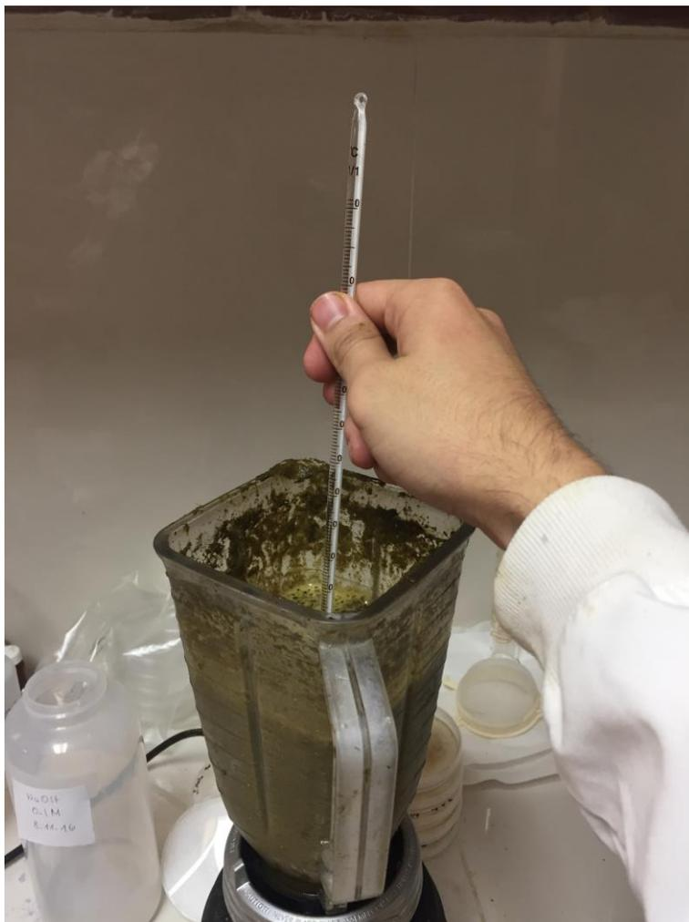
Figura 7. Molido de la moringa en licuadora, dependiendo del método en una solución alcalina o en agua destilada a 0°C. Monitoreo de pH/temperatura cada 3 minutos.
