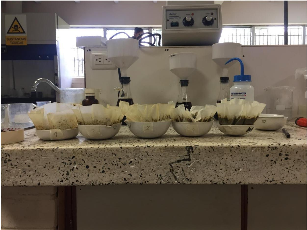
Figura 13. Numeración de las muestras, y transferencia a un crisol para su secado.
