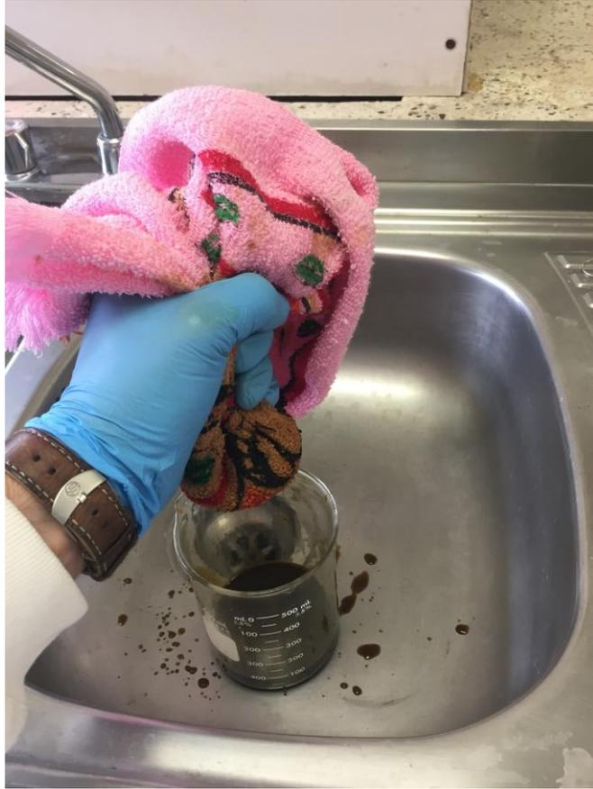
Figura 9. Filtrado del molido a través de una tela de algodón, para la obtención de un jugo protéico
