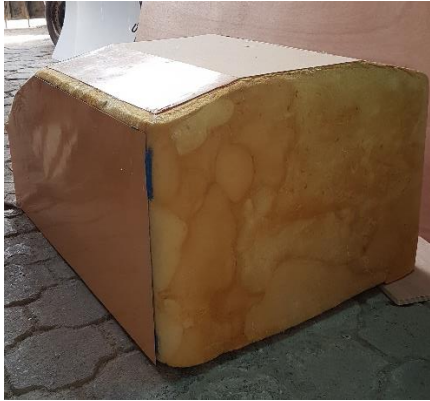
Imagen 71: Foto matriz forrada con fibra de vidrio. Fuente: propia.
