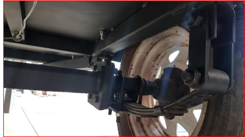
Imagen 26:Suspensión de ballesta. Fuente: propia.
