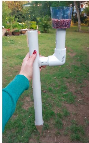
Primer prototipo: se decidió ponerle altura ajustable, la cual se puede ver en el segundo prototipo.
