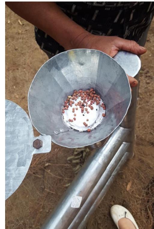
Cuenta con contenedor para las semillas en la parte superior para facilitar el transporte de las mismas.
