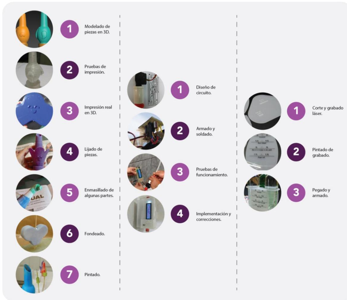
Ilustración 180: flujo de producción de prototipo.
