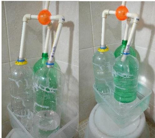
*Ilustración 96: validación divisor de flujo, prueba 2.*
