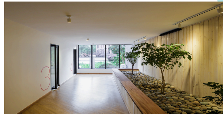
Fig. 64: Muro forrado con pino de \frac{1}{2} " x 4", piso laminado y jardín japonés.
