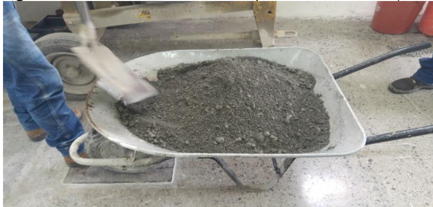
Figura 16: Mezcla de concreto compactado con rodillo (CCR)
