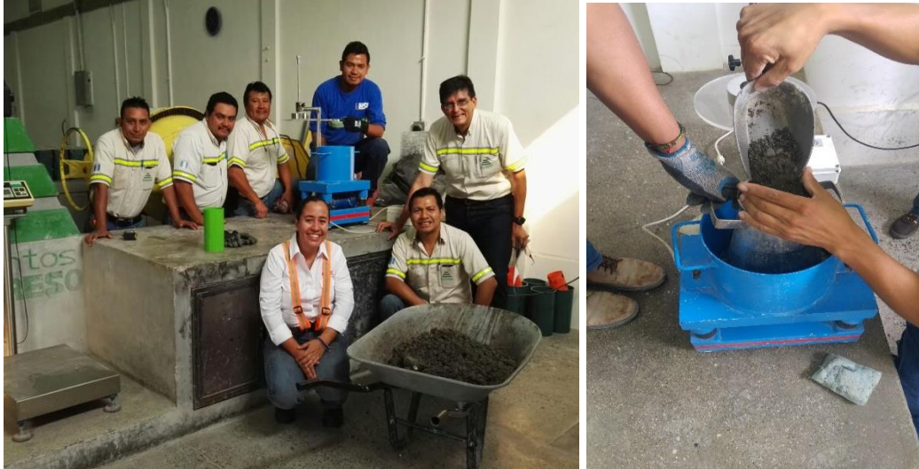
Figura 22: Ensayos (a) Materiales y equipo listos para empezar ensayos, (b) Llenado de Molde para ensayo, (c) Disco sobre mezcla.
