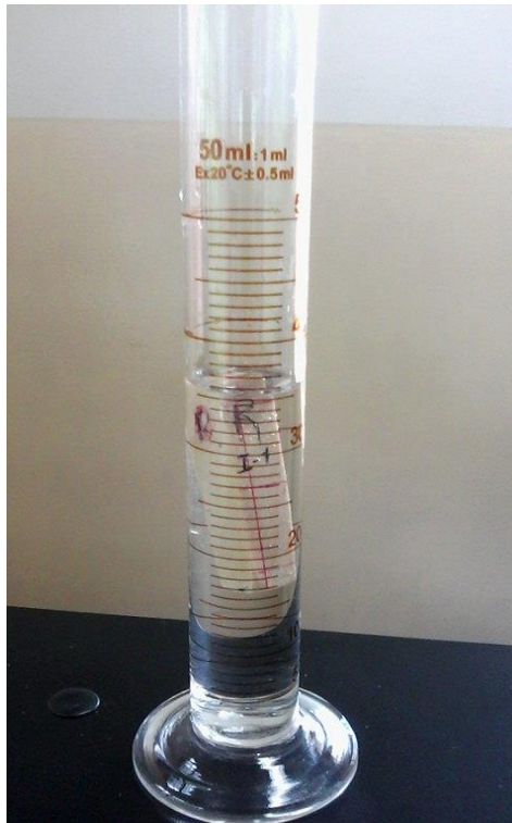
Figura 19. Muestra la determinación del volumen a través del método de desplazamiento, (norma ASTM). (Fuente: fotografía propia, 2008).
