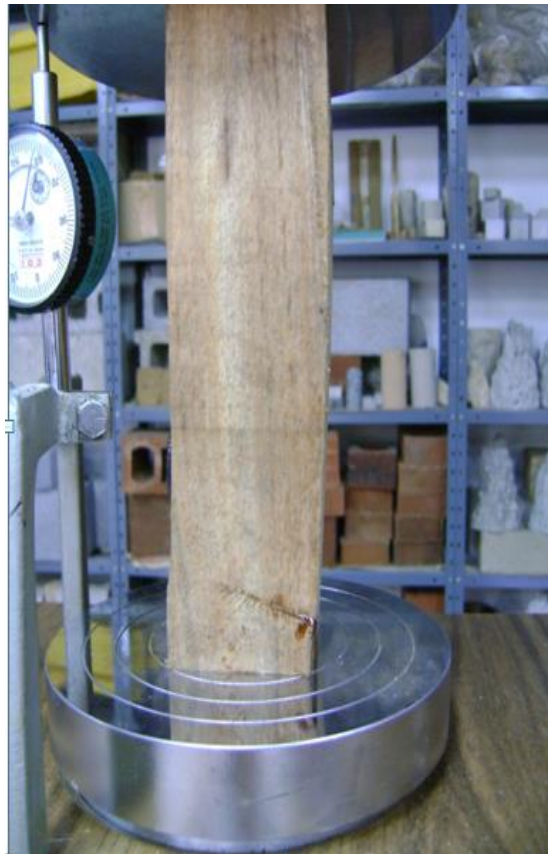
Figura 22. Probeta sometida a carga de compresión paralela a la fibra, se observa falla ocasionada en forma de cuña. (Fuente: fotografía propia, 2008).
