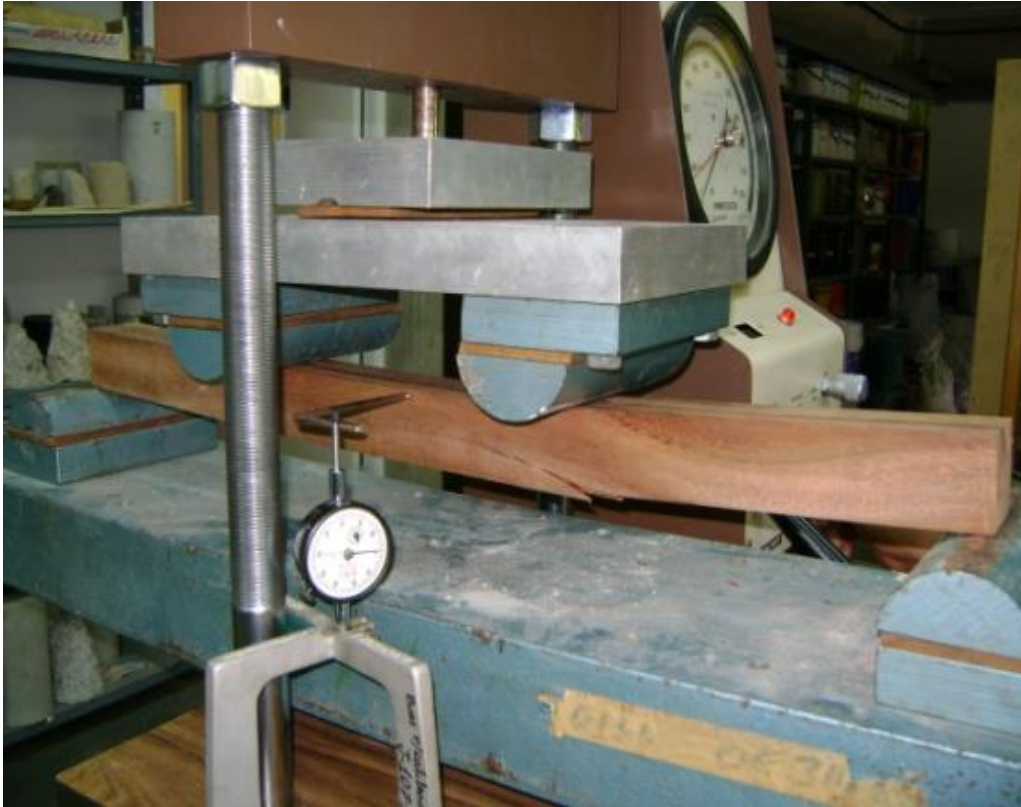
Figura 26. Máquina compresora realizando ensayo de flexión estática, se visualiza falla brusca y fibrosa. (Fuente: fotografía propia, 2016)
