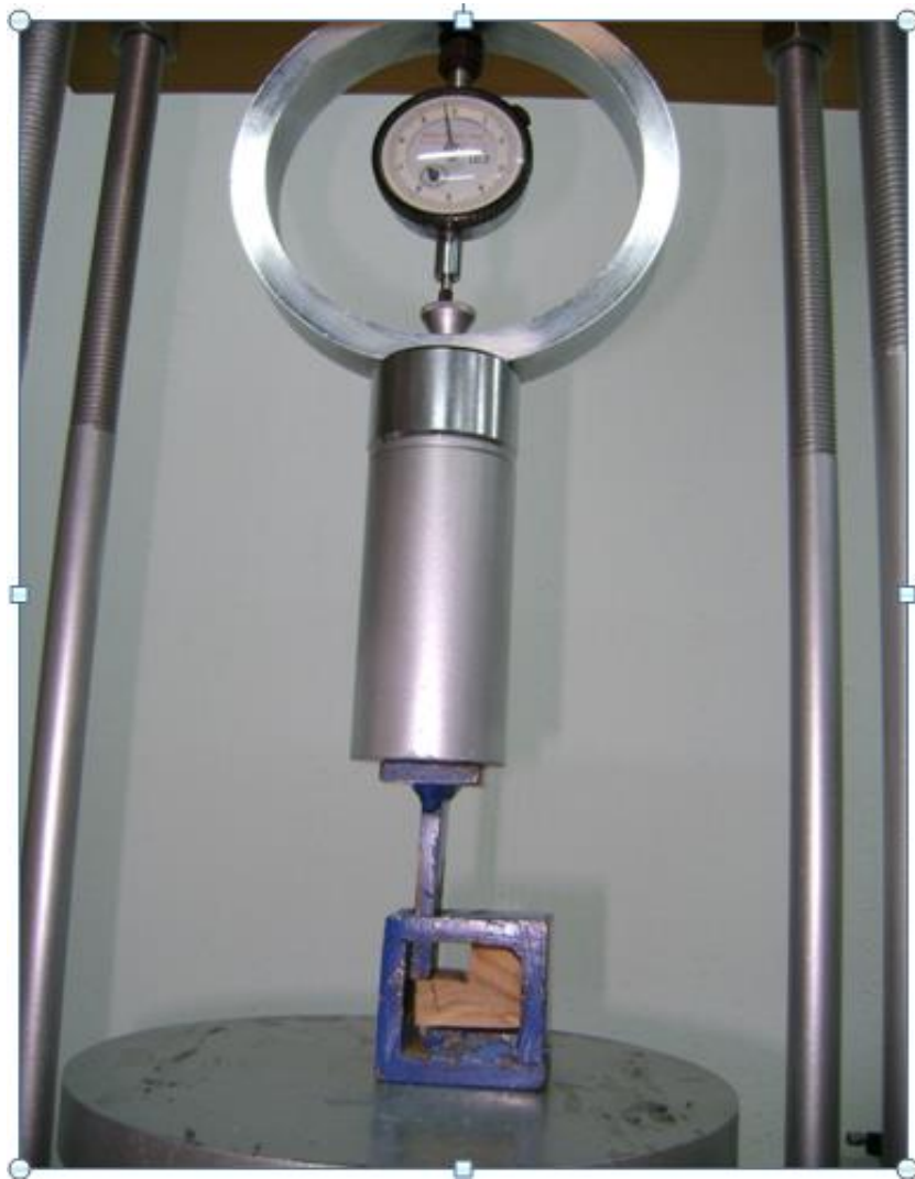
Figura 24. Compresora hidráulica que muestra la falla en el ensayo de corte. (Fuente: fotografía propia, 2008).
