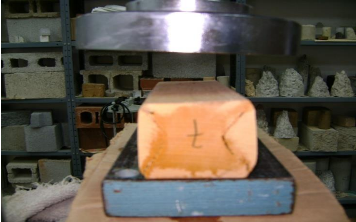
Figura 23. Probeta después de haber sido sometida a carga de compresión perpendicular a la fibra, se observa cierta cantidad de agua que emitió por el esfuerzo de compresión. (Fuente: fotografía propia, 2008).
