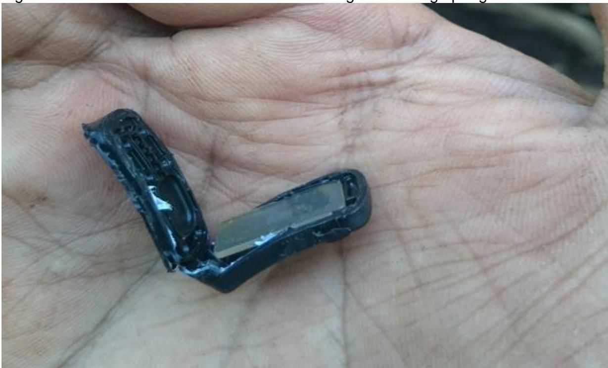
Figura 10. Efecto de los ácidos húmicos en los goteros.
