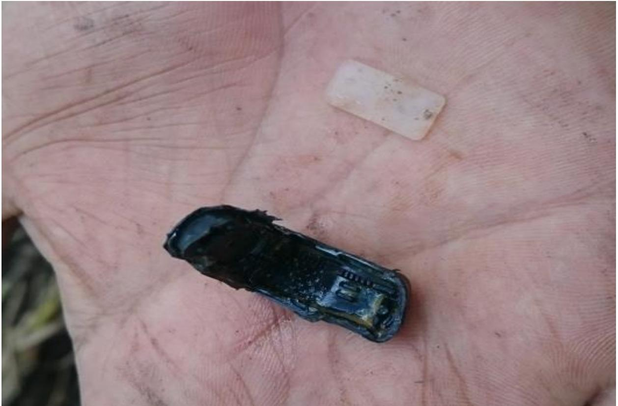
Figura 12. Estado de goteros sin ninguna aplicación de ácidos húmicos.
