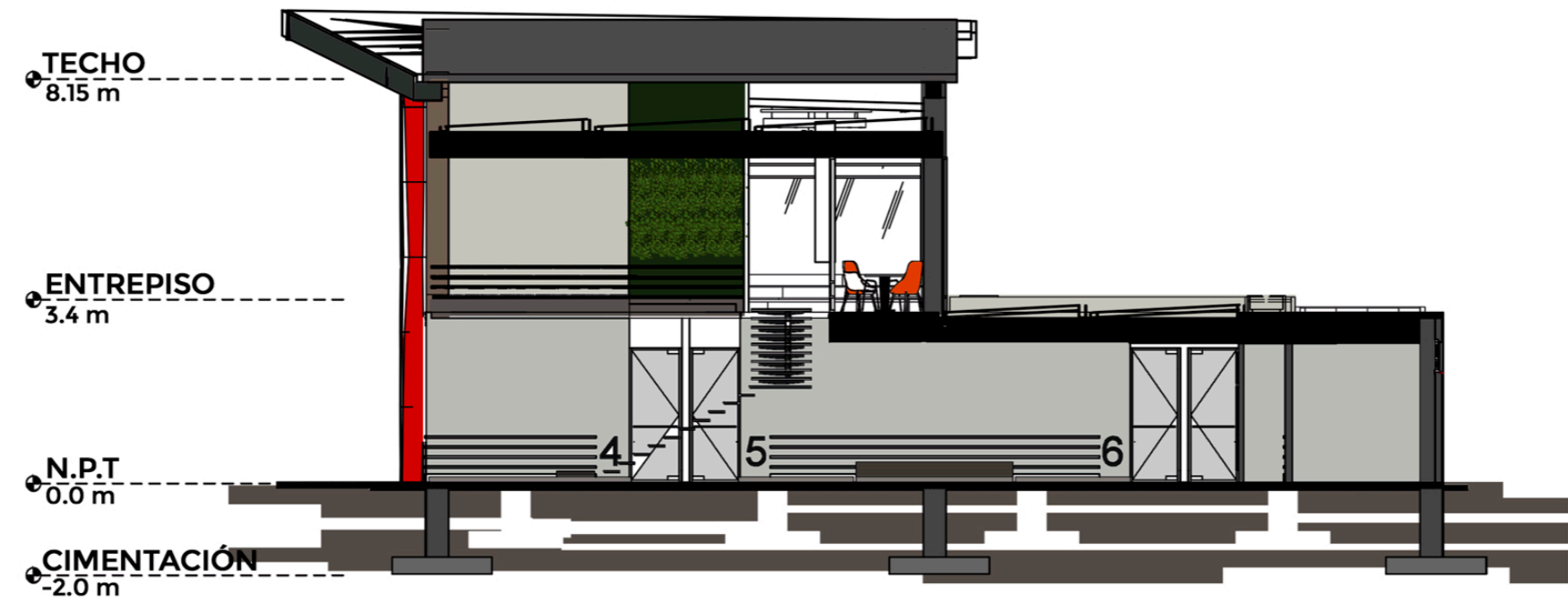
SECCIÓN LATERAL EDIFICIO A
