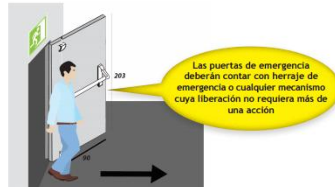
Puerta de emergencia según CONRED.
