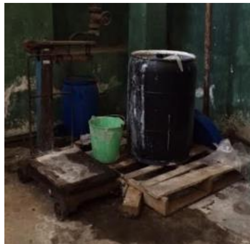
Ilustración 6. Báscula utilizada para el pesaje de hidróxido de sodio. Bodega de exclusiva de hidróxido de sodio.
