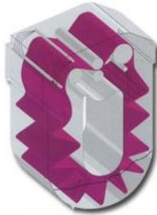
Ilustración 7. Movimiento del tejido al momento del teñido en la máquina FONG'S.
