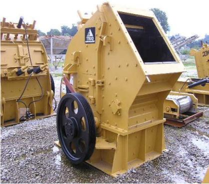
Una trituradora, chancadora o chancador, es una máquina que procesa un material de forma que produce dicho material con trozos de un tamaño menor al tamaño original. Chancadora es un dispositivo diseñado para disminuir el tamaño de los objetos mediante el uso de la fuerza, para romper y reducir el objeto en una serie de piezas de volumen más pequeñas o compactas.
