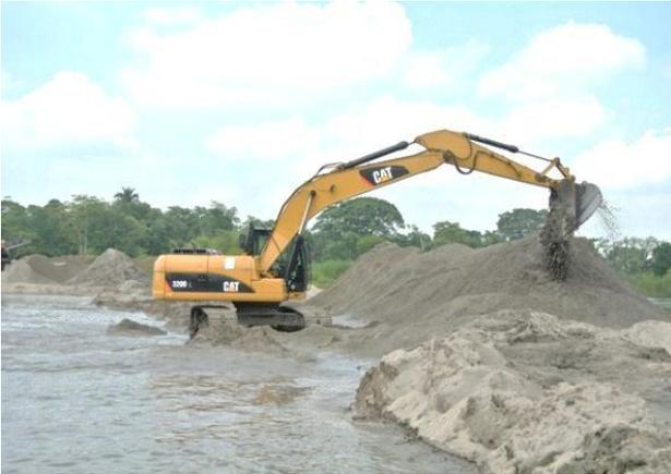
Se denomina pala excavadora a una máquina autopropulsada, sobre neumáticos u orugas, con una estructura capaz de girar al menos 360° (en un sentido y en otro, y de forma ininterrumpida) que excava terrenos, o carga, eleva, gira y descarga materiales por la acción de la cuchara, fijada a un conjunto
