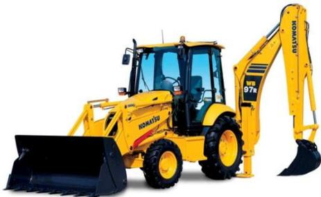
La retroexcavadora es una máquina que se utiliza para realizar excavaciones en terrenos. Es un vehículo multiuso que combina las habilidades de una excavadora con una cargadora.
