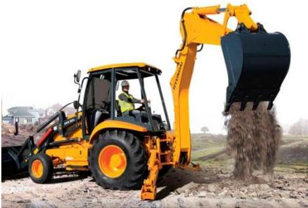
Una retroexcavadora, también conocida como pala mecánica, es una pieza de equipo principalmente utilizada para cavar en el piso y remover grandes cantidades de tierra, grava o arena. La retroexcavadora, a diferencia de la excavadora frontal, incide sobre el terreno excavando de arriba hacia abajo. Es utilizada para trabajar el movimiento de tierras a nivel inferior al plano de apoyo, o un poco superior a éste.
