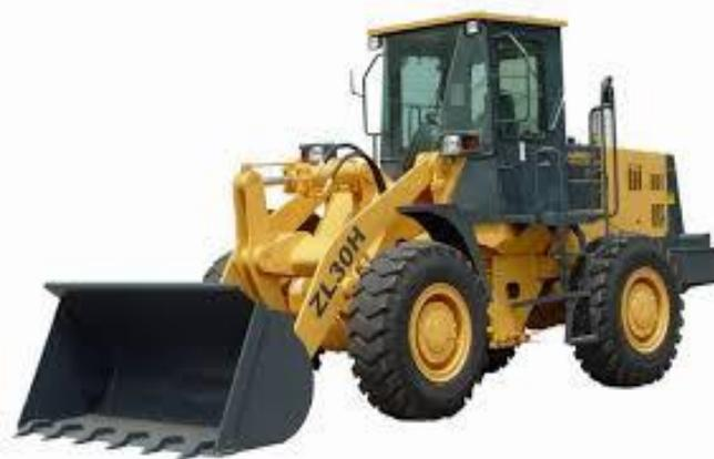
Denominamos como cargadora (según norma UNE 115-405-88) a la máquina autopropulsada sobre ruedas o cadenas, equipada con una cuchara frontal, su estructura soporte y un sistema de brazos articulados capaz de cargar y excavar mediante su desplazamiento y el movimiento de sus brazos, y de elevar, transportar y descargar materiales.
