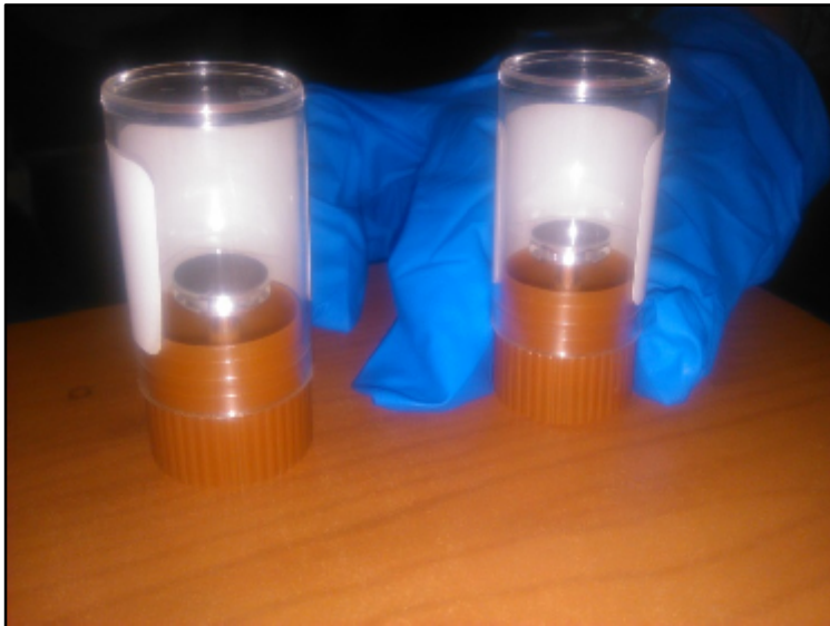
Figura 15: Kit de prueba Microscopía Electrónica de Barrido para obtención de residuos de pólvora.
