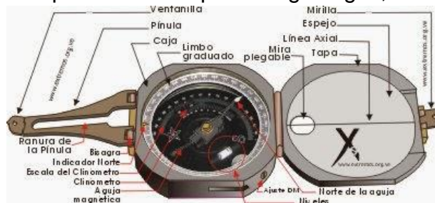
Figura 3. Brújula y sus Partes.
