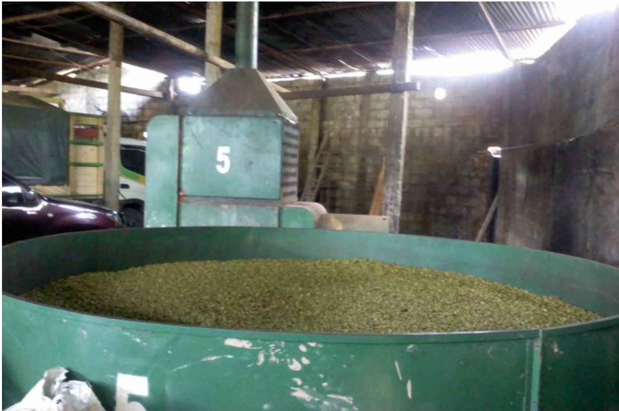
Figura 1. Fotografía de una pila secadora de cardamomo; iniciando el proceso de secado. Fuente (Fotografía propia, enero de 2013).
