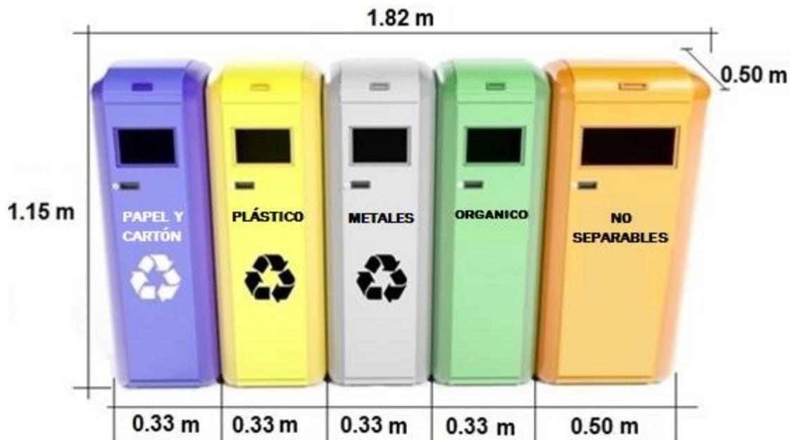
Figura 16. Diseño de basureros por clasificación en fuente.
