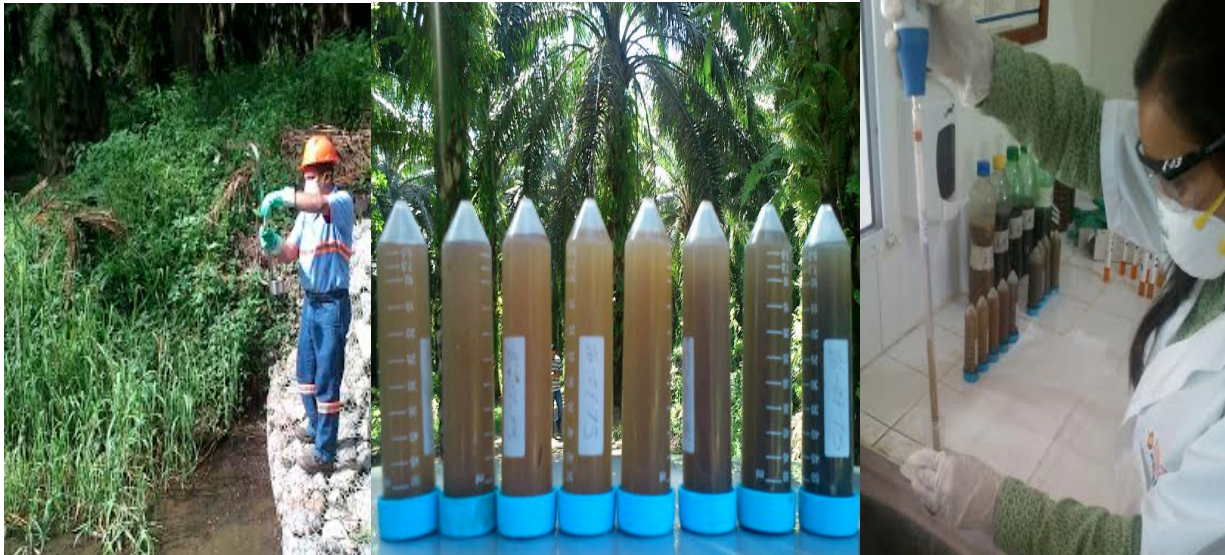
Figura 19. Muestreo y análisis de DQO en los tratamientos de fitodepuración.
