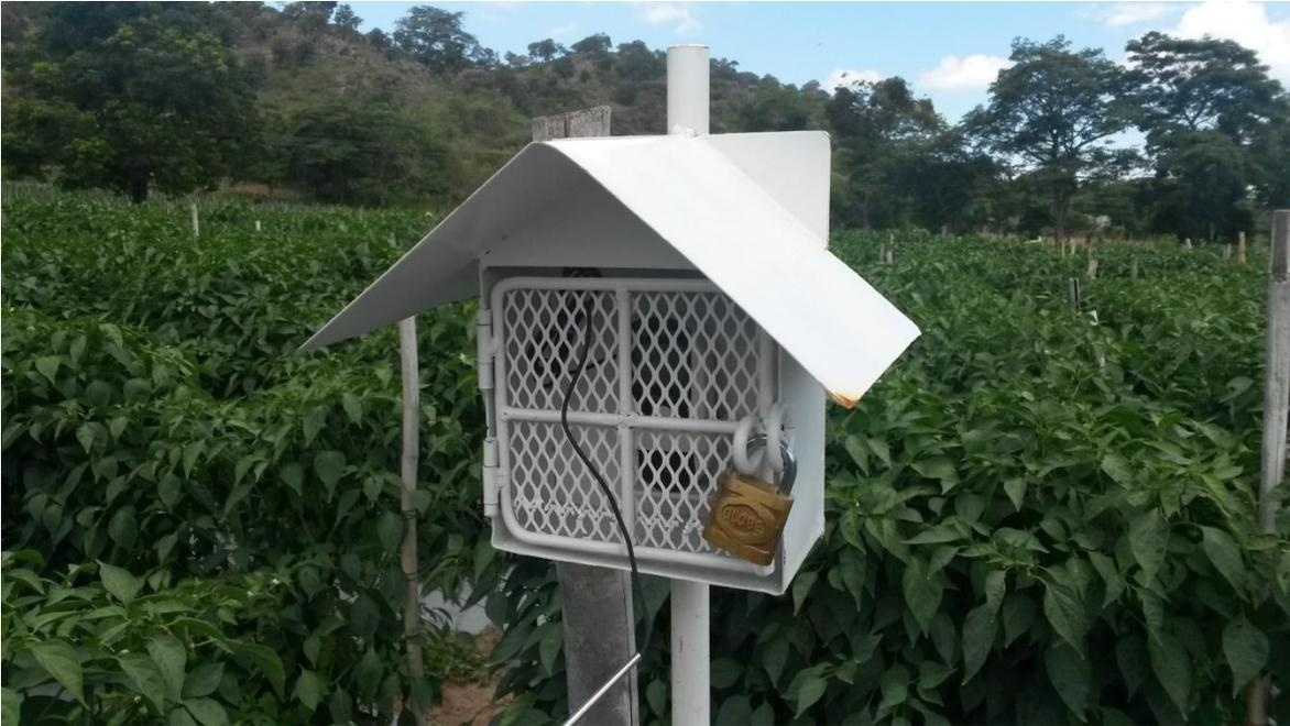
Figura 8. Instalación de Datalogger, para almacenamiento de información, temperaturas y humedad.
