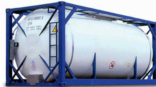
Ilustración 24: Contenedor tipo Tank. (PRADICAN, 2013)
