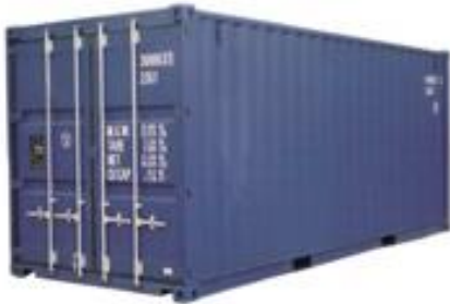
Ilustración 17: Contenedor tipo Dry Van. (PRADICAN, 2013)
