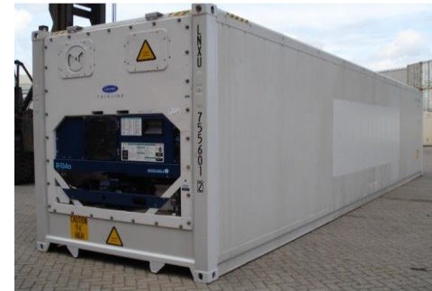
Ilustración 20: Contenedor tipo Reefer. (PRADICAN, 2013)
