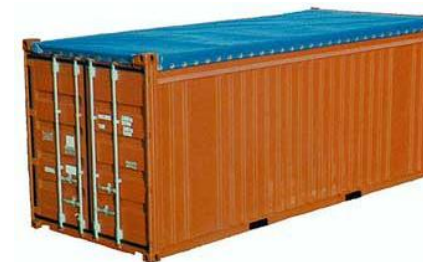
Ilustración 21: Contenedor tipo Open Top (PRADICAN, 2013)
