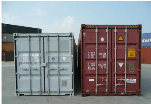
Ilustración 19: Contenedor tipo High Cube. (PRADICAN, 2013)
