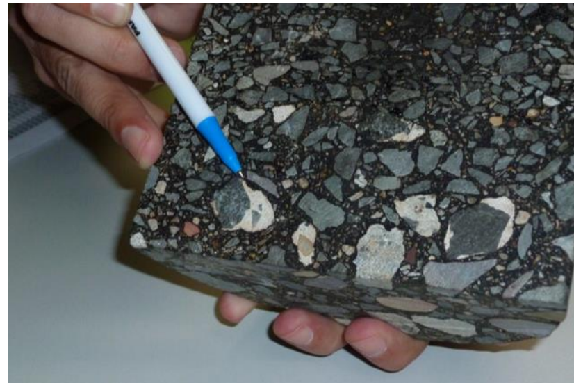
Fotografía 12. Muestra de asfalto con un 95% de agregado reciclado.
