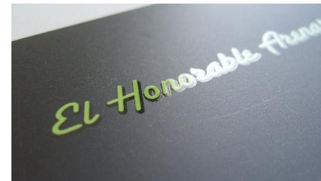
Thermography: Es la aplicación de un polvo después de haber imprimido en el material y luego pasarlo por un aparato de calor.
