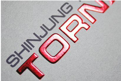
Barniz UV: Es un barniz plástico aplicado a través de screen printing. Puede aplicarse a toda la superficie o imprimir elementos específicos en barniz.
