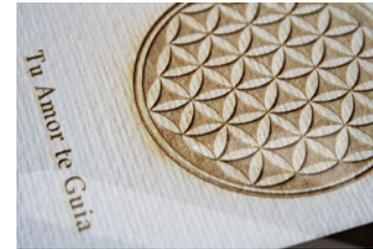
Foil: Se refiere al método de transferir una lámina metálica con una figura específica a través de la aplicación de calor.
