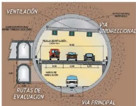
Se propone un paso vehicular subterraneo el cual tambien tendra acceso al estacionamiento de la central de metro, el tunel de aprox 1 km de longitud cuenta con sistemas de ventilación y filtración de c02 para reducir el riesgo de contaminación por gases atrapados.
