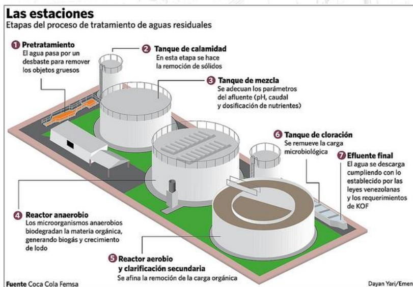
Ilustración 31 Etapas del proceso de tratamiento de aguas residuales. (Yari/Emen, s.f.)
