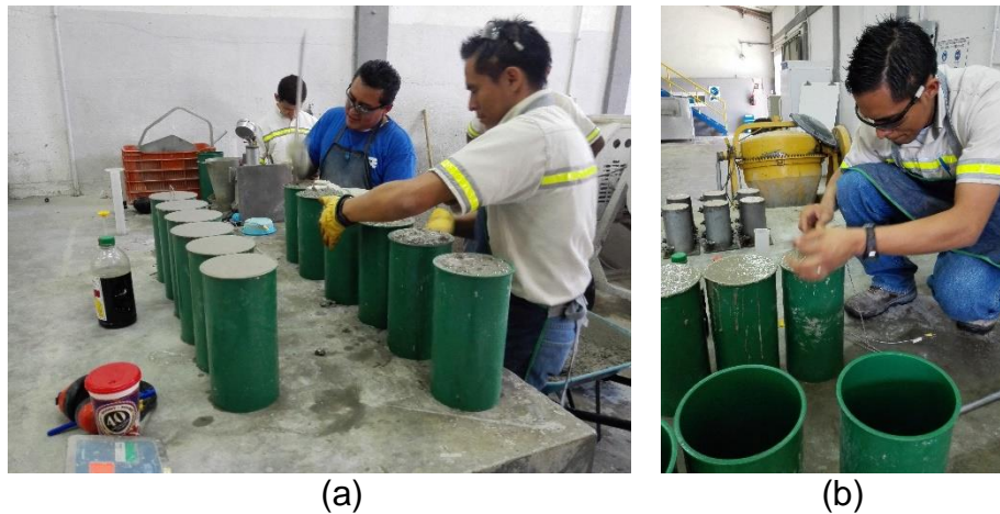
Figura 41: Realización de los especímenes cilíndricos (a), y en la siguiente figura se muestran la inserción de los sensores de temperatura en los especímenes (b).
