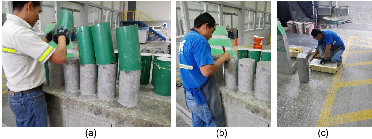
Figura 43: Desencofrado de especímenes cilíndricos (a), marcado de especímenes (b), y en la siguiente figura se muestran el desencofrado de las vigas de concreto (c).
