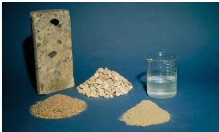
Figura 9: Componentes fundamentales del concreto: Cemento, agua, agregado grueso y agregado fino.
