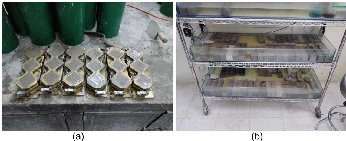
Figura 35: Se muestra fraguado inicial de los cubos en el laboratorio físico del CETEC, el cual cuenta con una temperatura controlada de 23 ° C (a) y en la siguiente imagen se muestra el baño de curado en donde fueron sumergidos (b).
