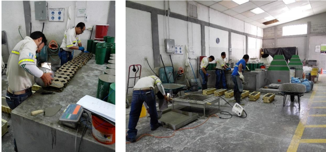
Figura 33: Momento de elaboración de las series de cubos de 50mm (2 pulgadas) por técnicos especializados en morteros (a), y en la siguiente imagen se muestra al frente el procedimiento de tamizado para la obtención del mortero y en el fondo la realización de los cubos (b).
