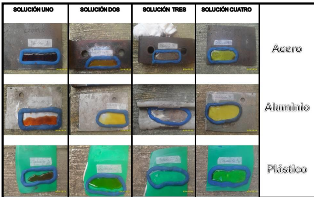
Figura 8. Revenido de acero, aluminio y plástico con cuatro tipos de soluciones distintas.
