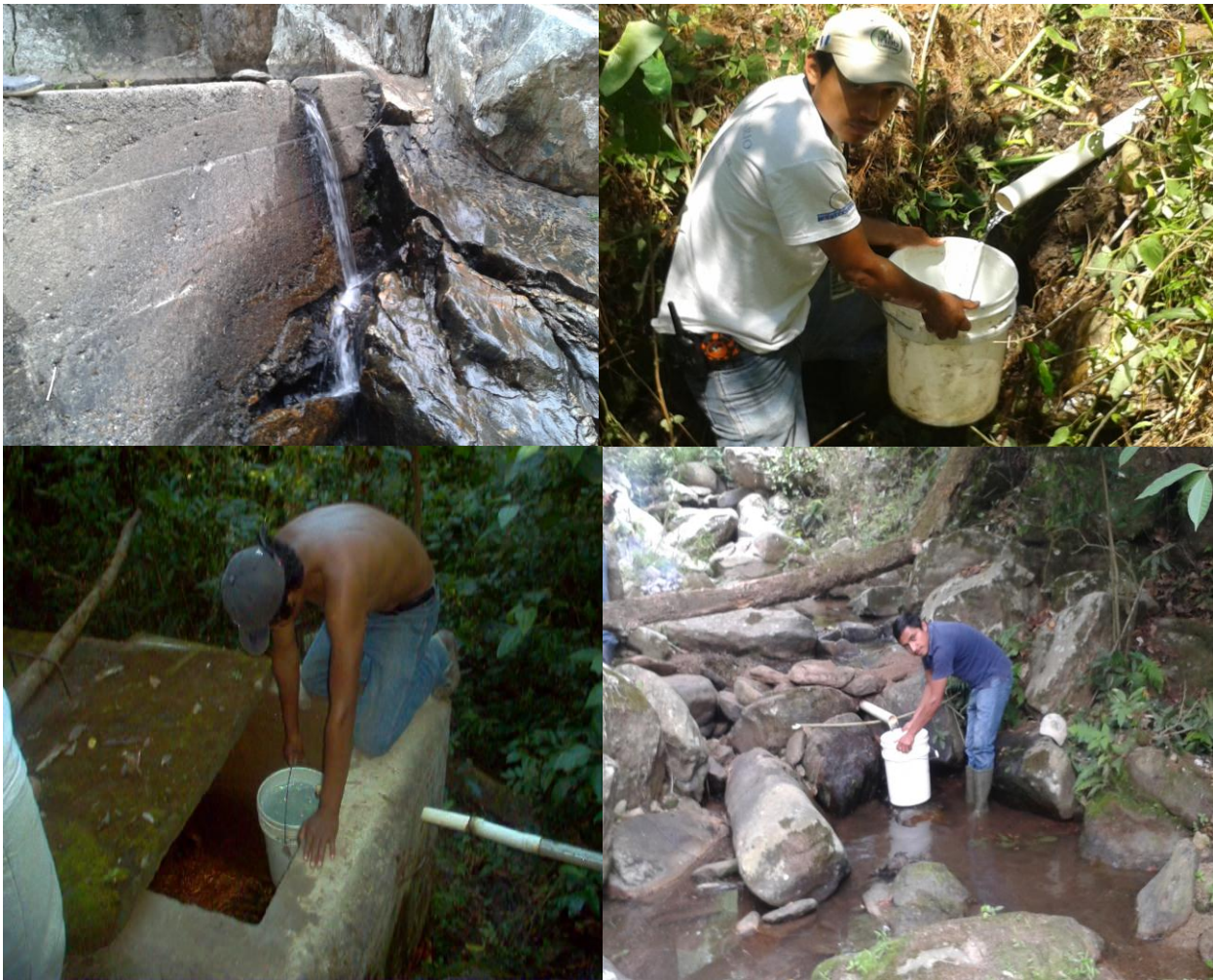
Figura 8. Medición del caudal en obras en cauce en quebradas y en nacientes (ojos de agua).
