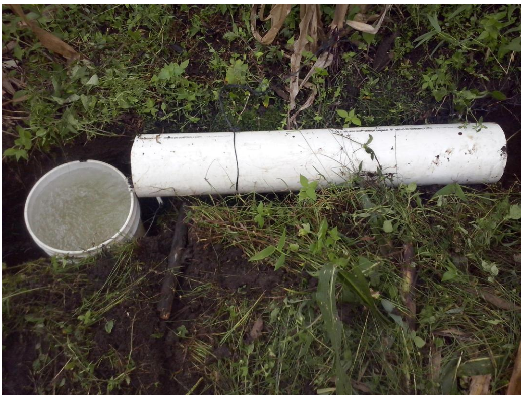
Figura 4. Aforo de Nacimiento a través del método Volumétrico.
