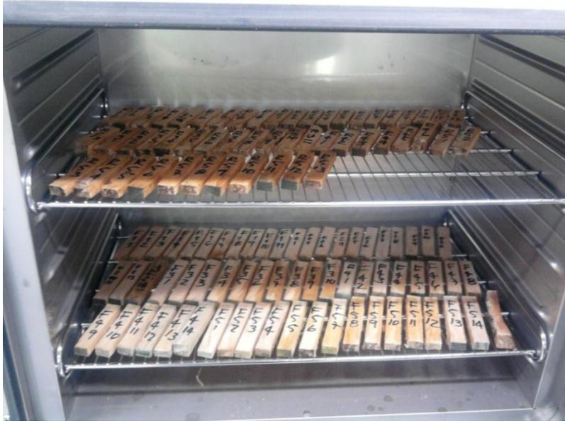
Figura 19. Piezas empleadas para la determinación de la densidad puestas al horno para secarlas.
