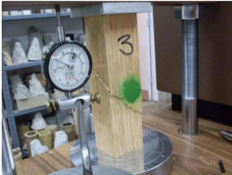
Figura 25. Probeta sometida a carga en compresión paralela a la fibra. Se observa la falla causada en forma de cuña.
