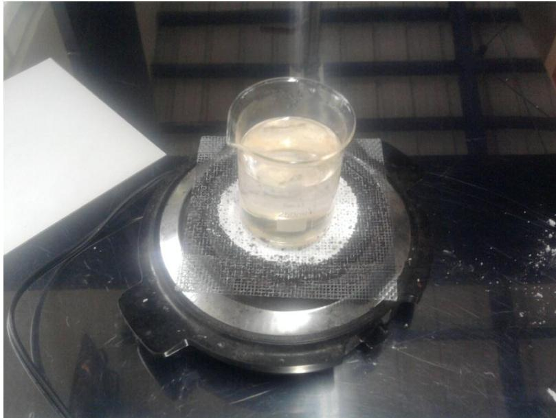
Figura 20. Preparación de la parafina empleada para recubrir las piezas de madera secas al horno para determinar el volumen por inmersión.
