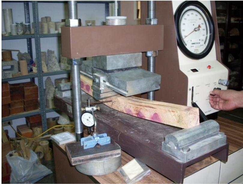
Figura 23. Probeta sometida a la prueba de flexión estática.
