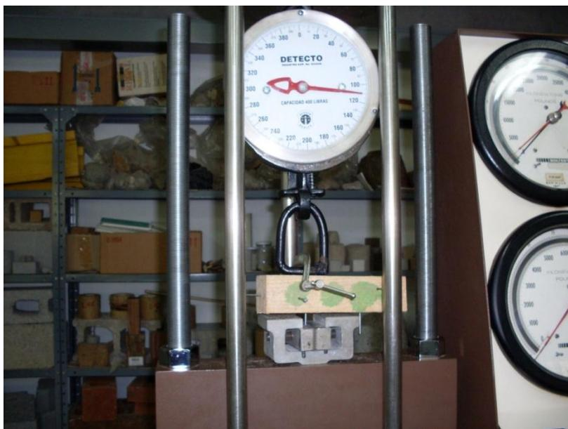
Figura 29. Probeta sometida a la prueba de retiro de clavos.
