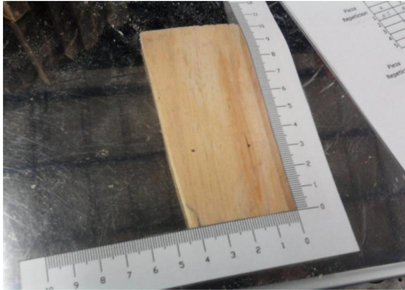
Figura 15. Medición de la inclinación de la fibra en las tablillas, utilizando la regla elaborada.
