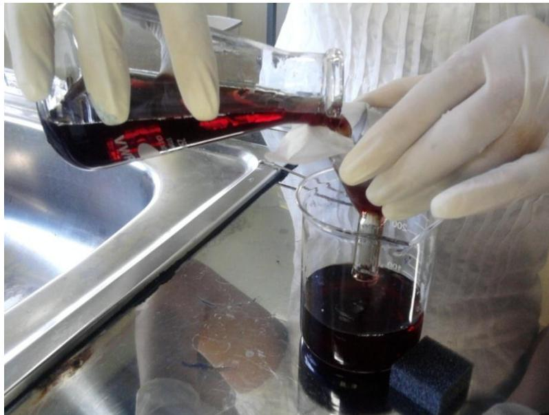
Figura 11. Preparación del Azul de Bromofenol para realizar la determinación de la albura y el duramen en las piezas de madera.
