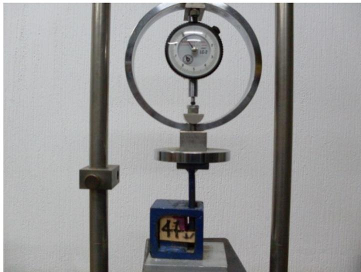
Figura 28. Probeta empleada para la determinación del esfuerzo de corte.
