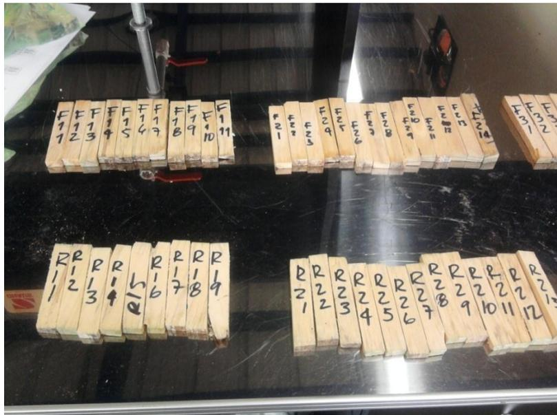
Figura 16. Piezas para determinar la densidad. En la parte superior se observan las piezas correspondientes a la madera de corta final F, abajo las piezas obtenidas con la madera del raleo.
