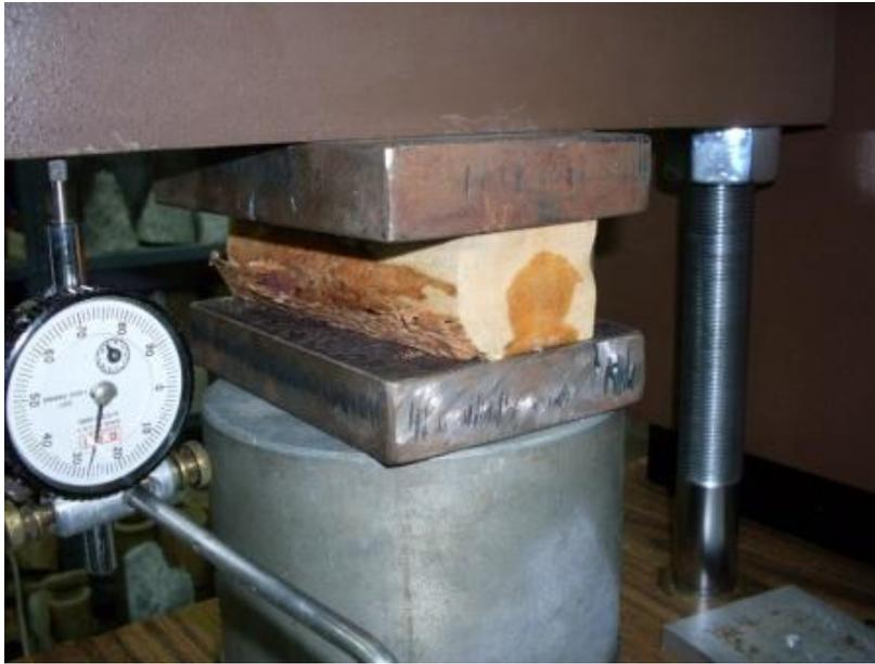
Figura 26. Probeta sometida a carga en compresión perpendicular a la fibra.
