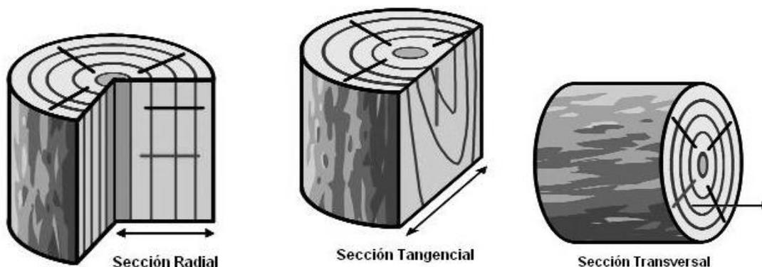
Figura 1. Secciones o planos de la estructura de la madera. (Adaptado de: Acuña y Casado, 2005).
