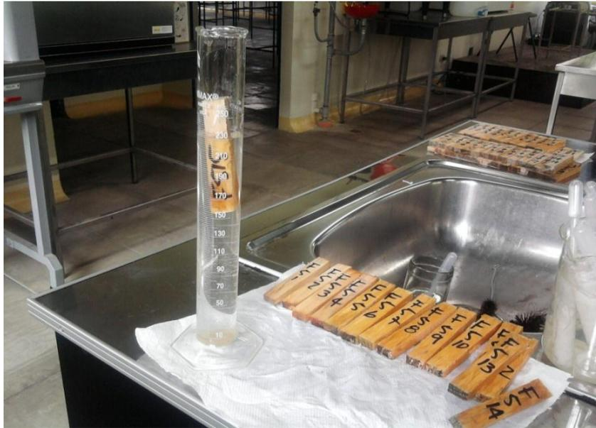
Figura 17. Determinación del volumen de las piezas de madera a través del método de desplazamiento.
