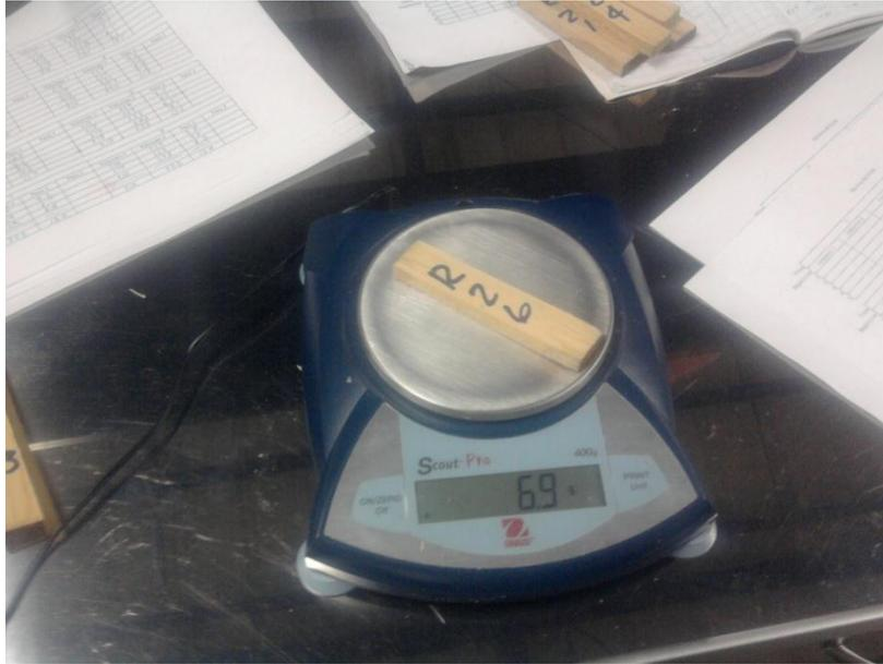
Figura 18. Determinación del peso de cada pieza utilizada para obtener la densidad de la madera.
