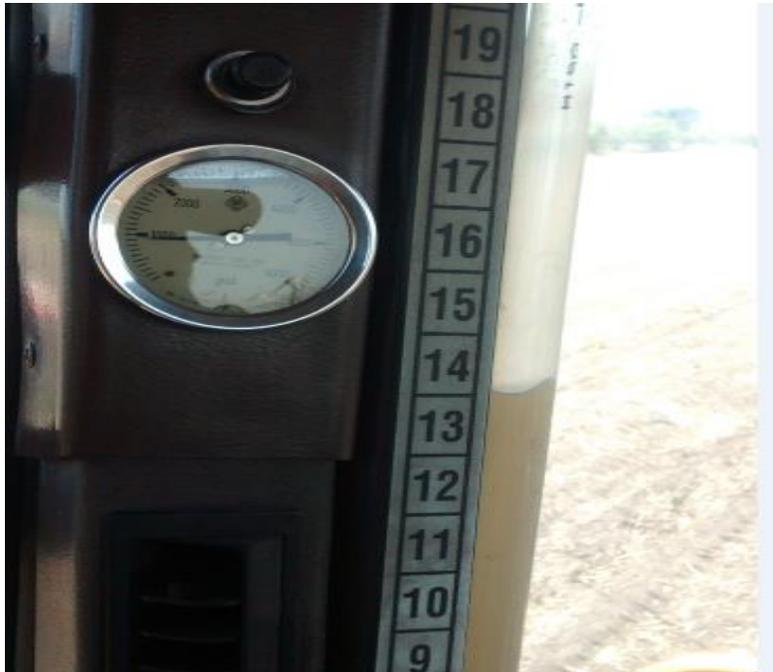
**Figura 13. Indicador de nivel y presión de corte**
