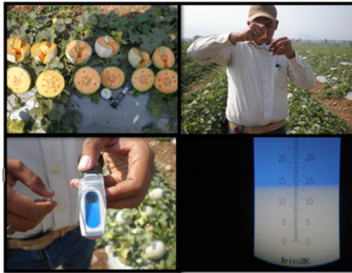
Anexo 14. Figura 23. Toma de datos de solidos solubles (grados brix) de la fruta.
