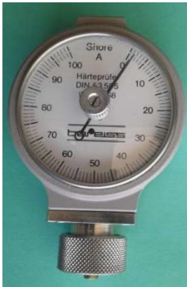
Figura 4. Penetrómetro Shore A Modelo 5023-2.
