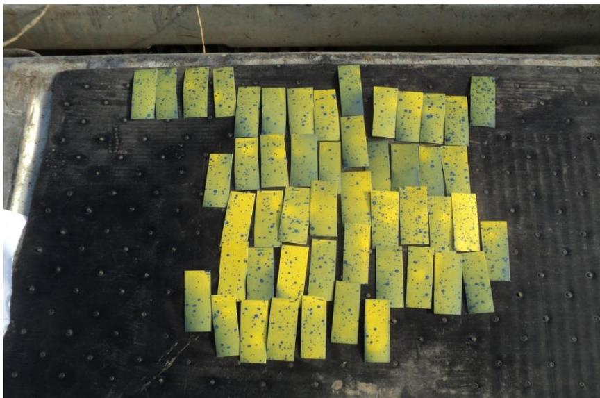
Figura 12. Tarjetas hidrosensibles listas para ser analizadas
