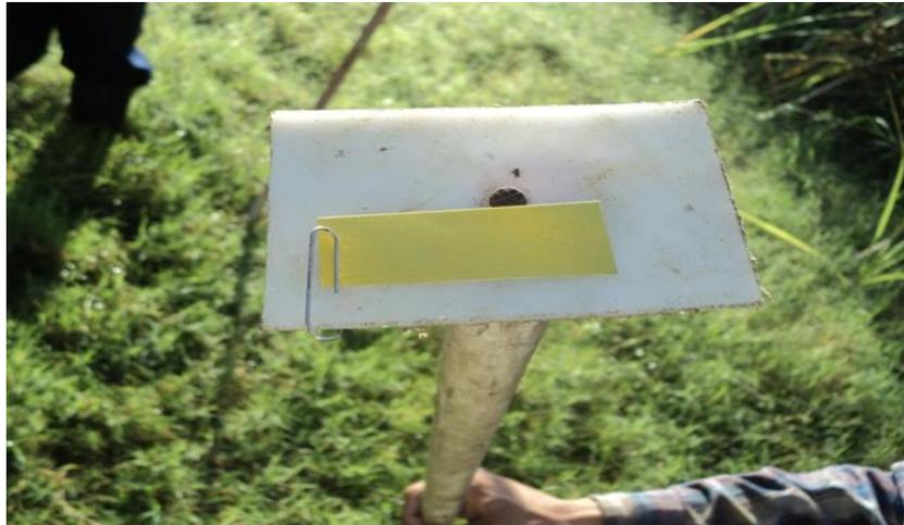
Figura 8. Colocación de tarjetas hidrosensibles
