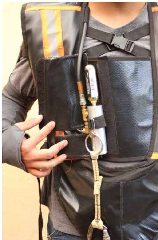
Imagen 65: Detalle sistema de carga de activación de CO2
