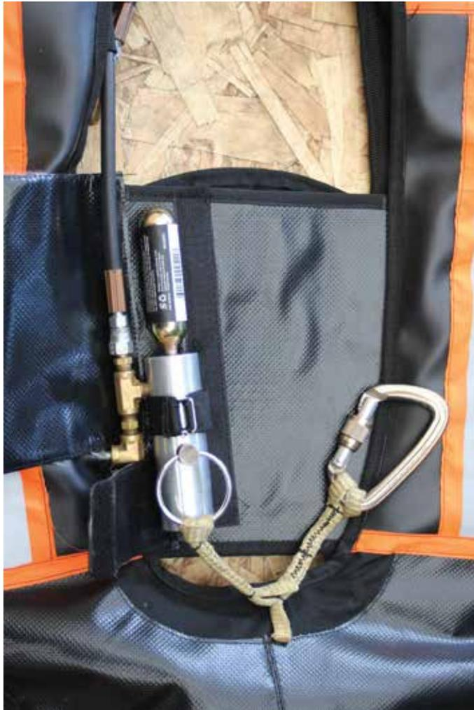
Imagen 68: Detalle sistema de carga de activación de CO2
