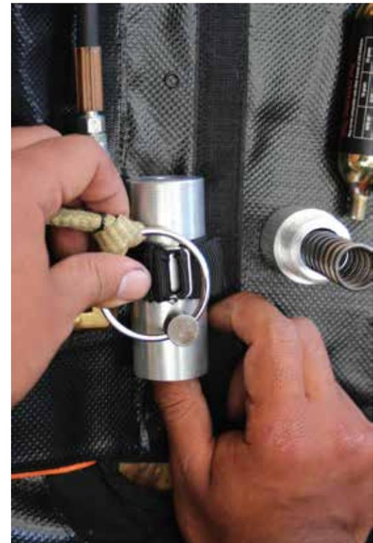
Imagen 76: se coloca la aguja y el pin de retención
