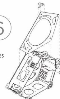
La placa frontal se desliza entre las uniones hasta llegar a su lugar para ser fijada.
