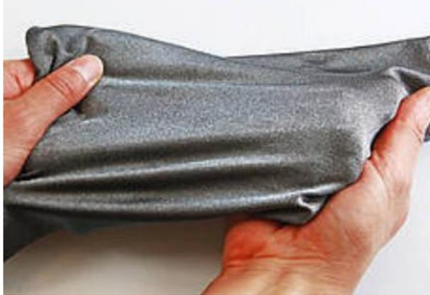
Ilustración 44 | Stretch conductive fabric, (LessEMF.com, 2014)
