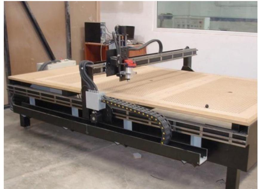
Ilustración 41 | Máquina de corte CNC, (MecanoCNC Guatemala, 2015)
