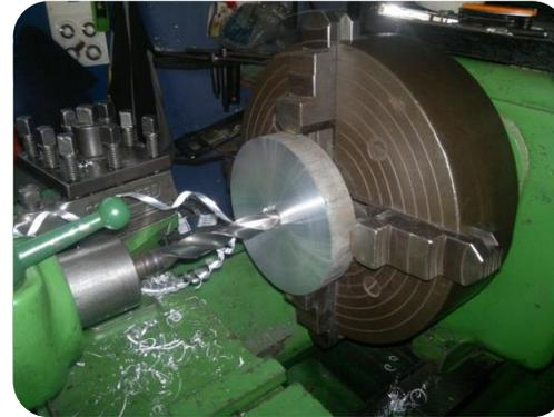
Imagen # 113: Perforación de la pieza de aluminio
