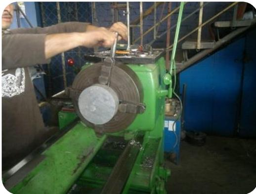
Imagen # 108: Colocación de pieza en el torno
