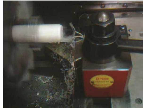
Lijado de tubo de acetato para crear media esfera
