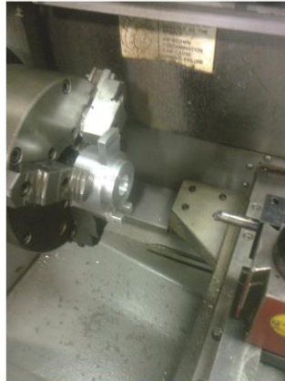
Corte de un trozo de aluminio para crear la forma
