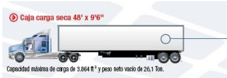
Imagen 2 – Descripción: Especificaciones caja carga seca 48' x 9'6- Fuente: http://www.revistadelogistica.com/vehiculos-para-el-transporte-de-carga-por-carretera.asp
