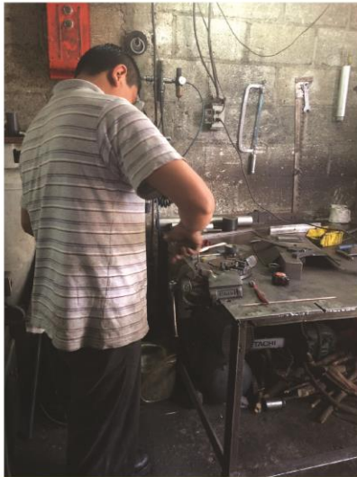
CORTE DE TUBO DE ALUMINIO
