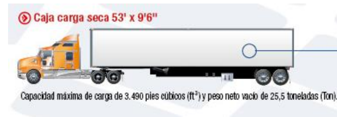
Imagen 1- Descripción: Especificaciones caja seca 53' x 9'6 – Fuente: http://www.revistadelogistica.com/vehiculos-para-el-transporte-de-carga-por-carretera.asp
