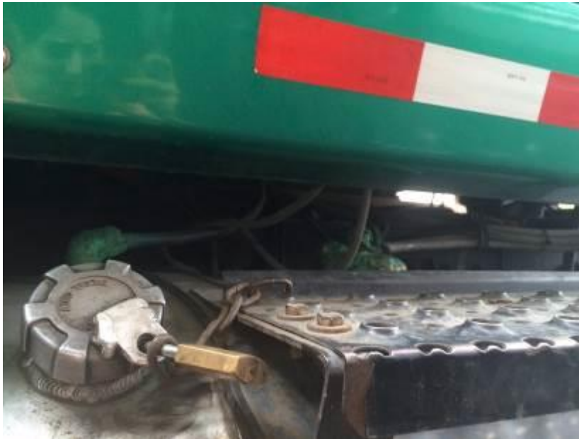
Imagen 23 – Descripción: Tapadera tanque de diésel – Fuente: Propia
