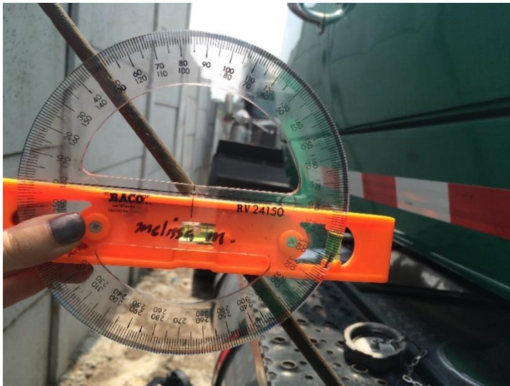
Imagen 26 – Descripción: Ángulo boca del tanque – Fuente: Propia
