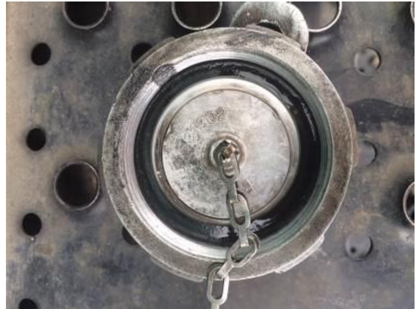
Imagen 24 – Descripción: Reverso de la tapadera del tanque – Fuente: Propia
