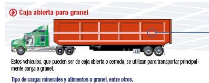
Imagen 4 – Descripción: Especificaciones caja abierta – Fuente: http://www.revistadelogistica.com/vehiculos-para-el-transporte-de-carga-por-carretera.asp
