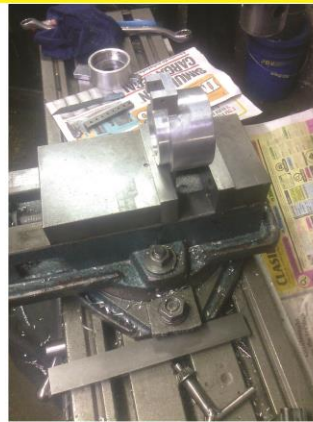
Colocación de tope en la tapadera
