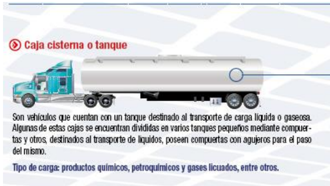
Imagen 3- Descripción: Especificaciones caja cisterna o tanque- Fuente: http://www.revistadelogistica.com/vehiculos-para-el-transporte-de-carga-por-carretera.asp
