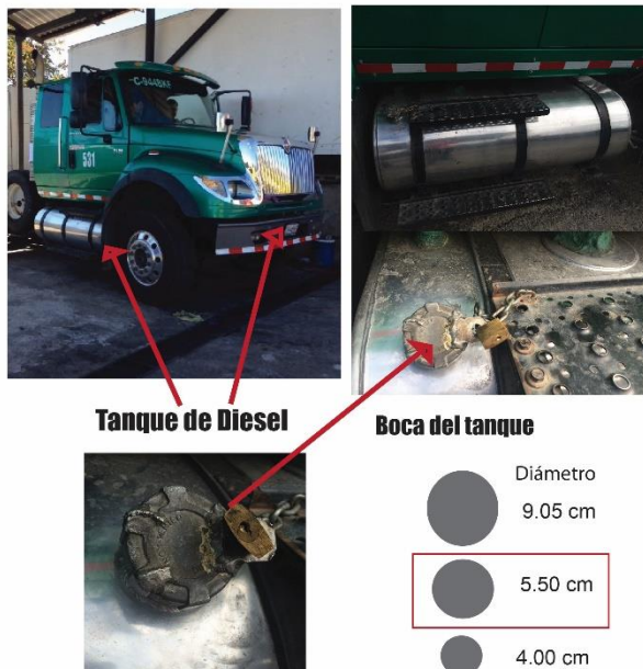
Imagen 19 – Descripción: Diagrama tanque de diésel en cabezal international – Fuente: Propia
