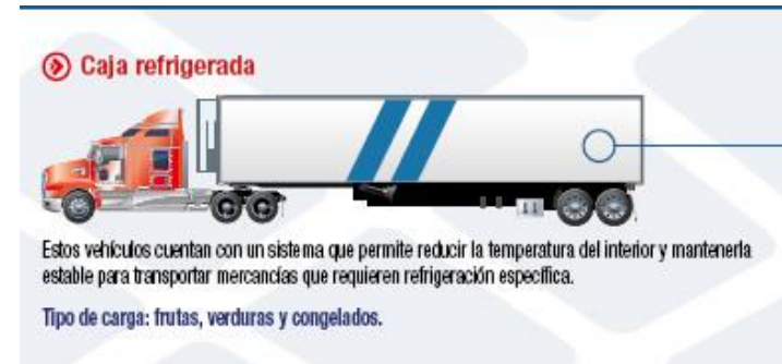
Imagen 5 – Descripción: Especificaciones caja refrigerada- Fuente: http://www.revistadelogistica.com/vehiculos-para-el-transporte-de-carga-por-carretera.asp
